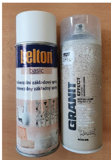
obr. 41 Kombinace barev ve spreji pro tvorbu stochastické sítě
