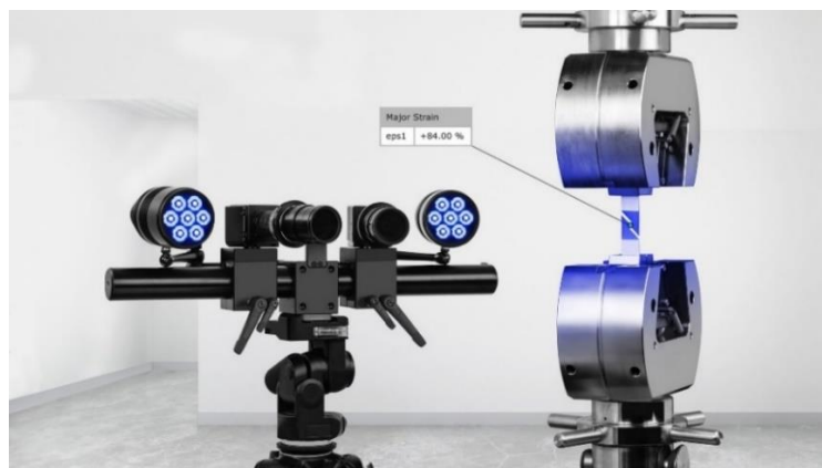
obr. 24 Měření pomocí systému ARAMIS [34]
