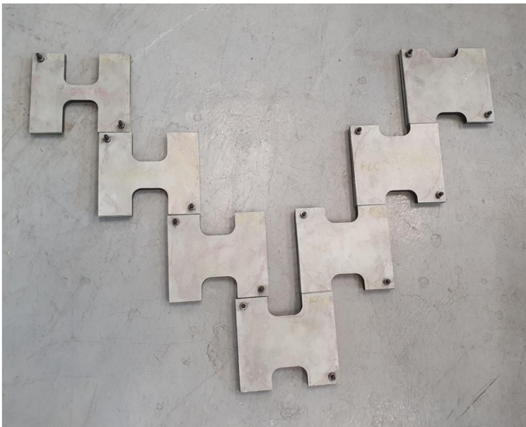
obr. 38 Sedm geometrií vyrobených pomocí WEDM ve tvaru FLC
