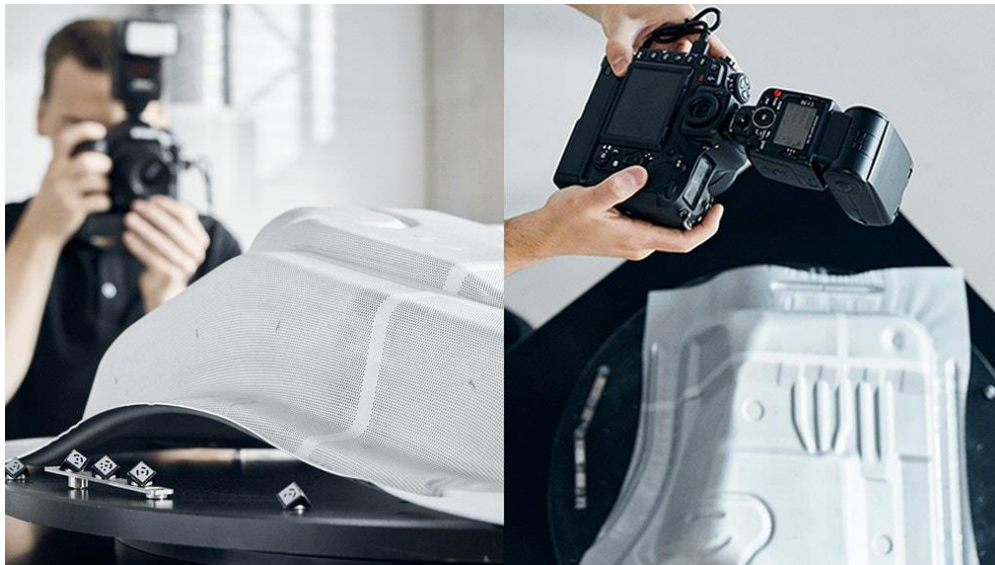
obr. 21 Měření vylisovaného dílu pomocí systému ARGUS [31]
