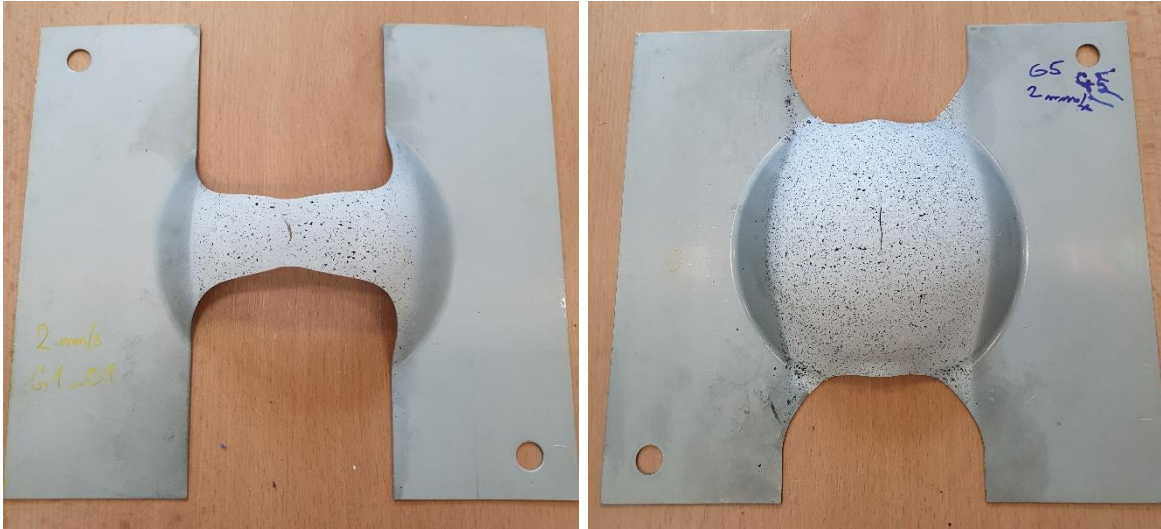
obr. 46 Vzorky se správnou polohou vzniku trhliny
