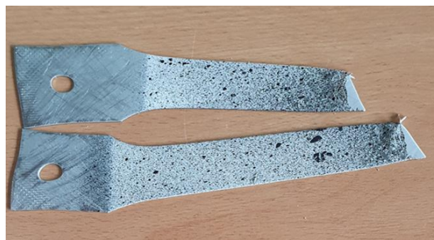
obr. 29 Loupání barev náhodného vzoru
