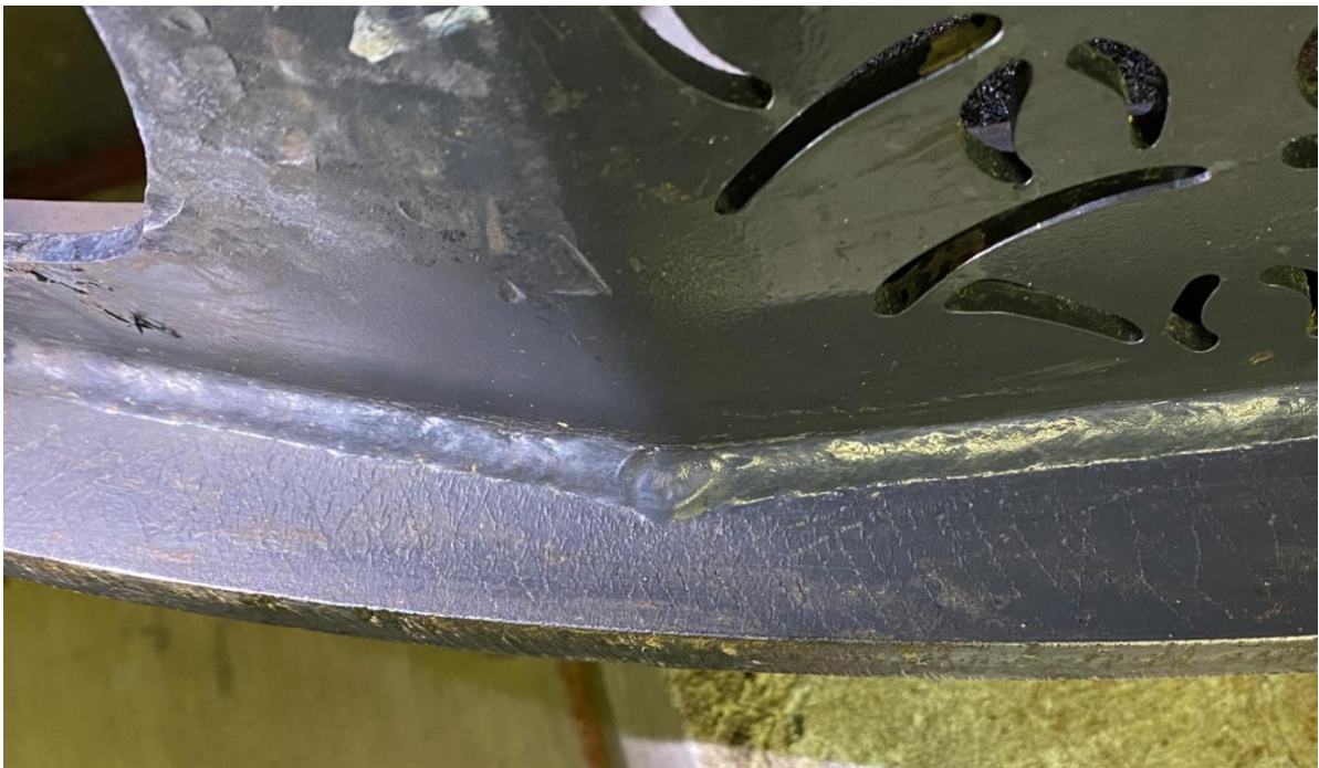
Obrázek 31 – Oblast nejhustěji popraskaného laku odpovídá zakreslenému směru
