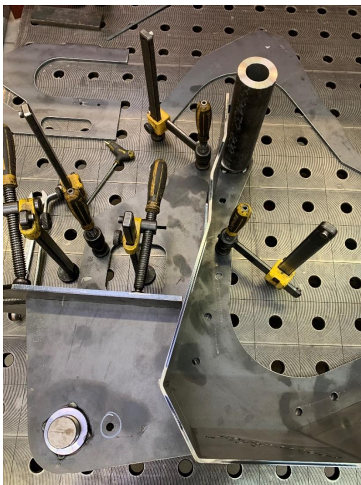
Obrázek 29 - Upnutí svařovací sestavy pomocí systému Siegmund System 28
