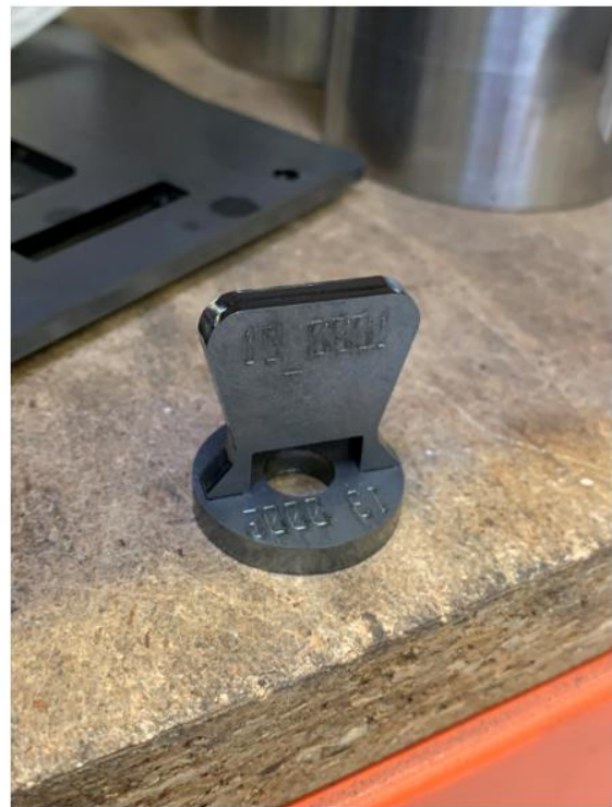
Obrázek 26 – Sestava dílů s fixačními zámký pro svařování bez přípravku
