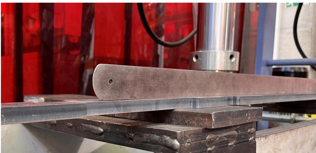
Obrázek 20 - Vůle mezi rovinou kalibrované měrky a rovinou výpalku
