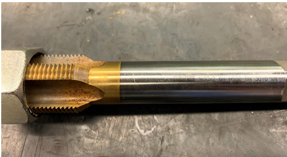
Obrázek 36 - Kontrola šroubení pomocí závitníku
