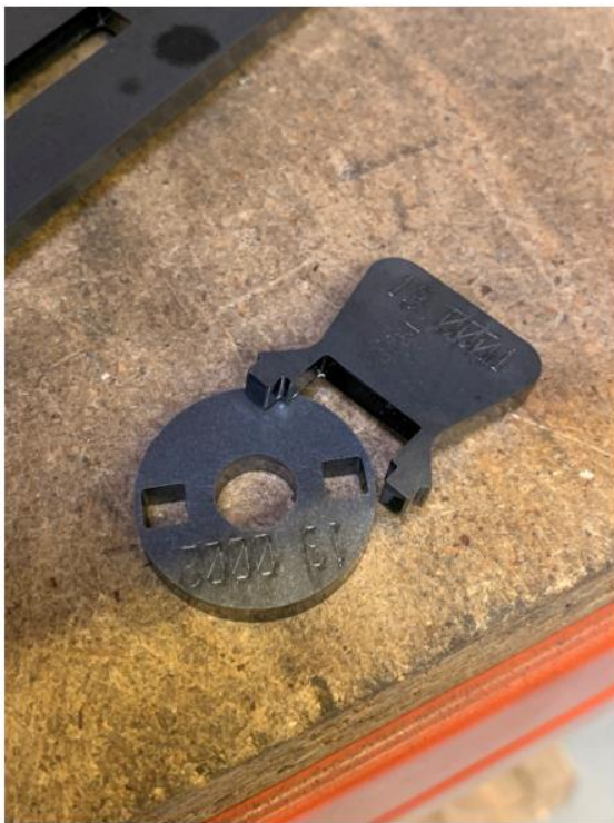
Obrázek 26 – Sestava dílů s fixačními zámký pro svařování bez přípravku
