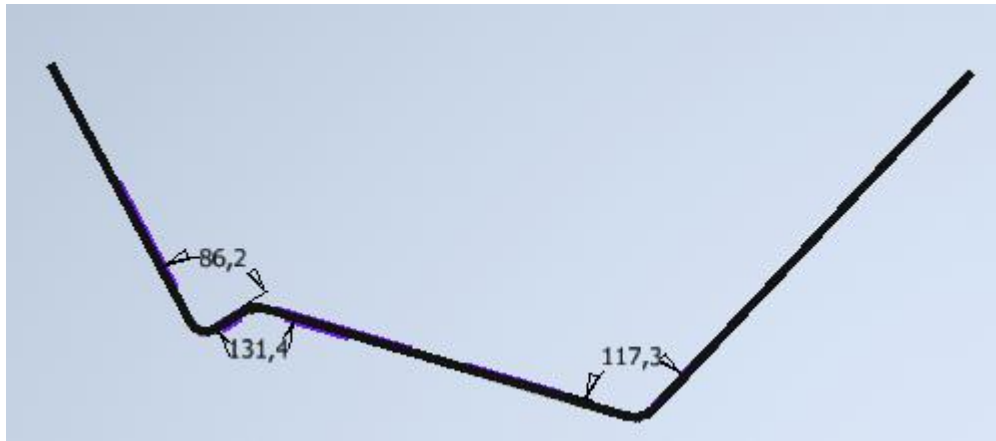
Obr. 61 Výsledná geometrie výlisku z první simulace ze Simufact formingu
