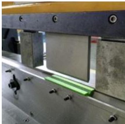
Obr. 26 Plastová vložka v lise [1]
