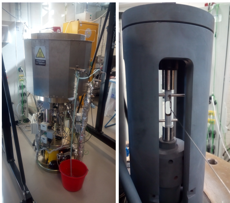
Obr. 3.6: Autokláv UJV (vlevo), uchycení vzorku při tahové zkoušce v autoklávu (vpravo)
