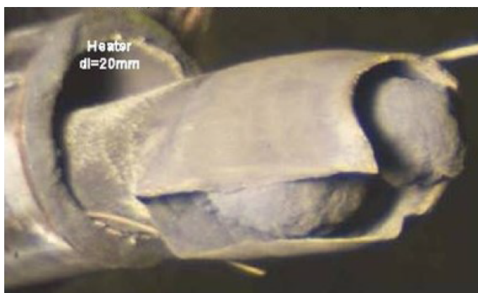
Obr. B.1: Selhání pokrytí po vyboulení - IFA-650.9 [38]
