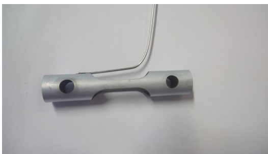
Obr. 3.8: Vzorek pro axiální tahovou zkoušku v autoklávu
