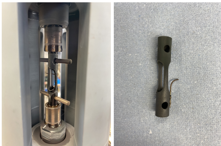
Obr. 3.16: Stav vzorku s chromovou ochrannou vrstvou po tahové zkoušce v prostředí PWR
