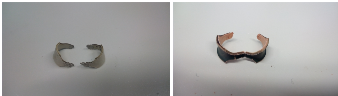
Obr. 3.28: Stav vzorků po creepové zkoušce, vlevo - Opt. ZIRLO™, vpravo - Opt. ZIRLO™ s chromovou ochrannou vrstvou
