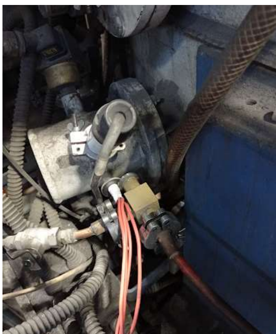
Obr. 32 Utěsnění vedení termočlánků ve vakuové peci
