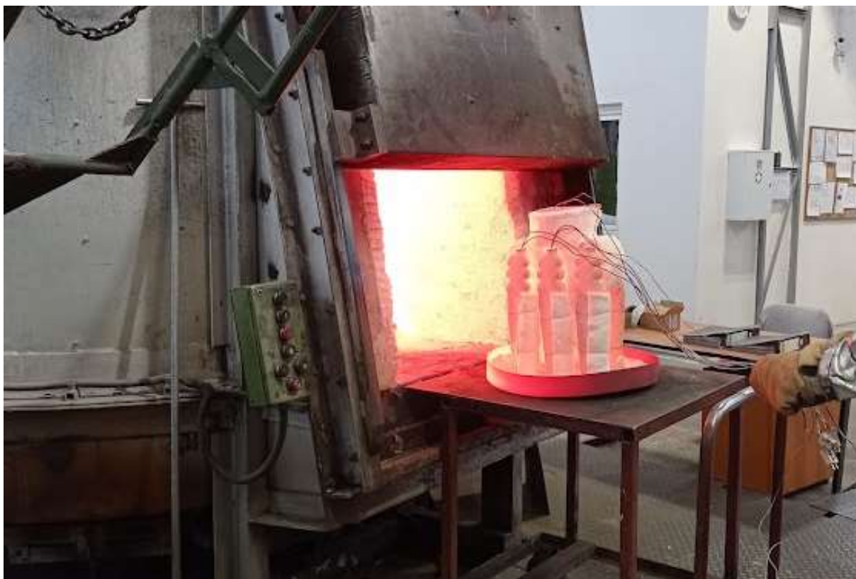
Obr. 40 Vsouvání skořepiny do předehřívací pece
