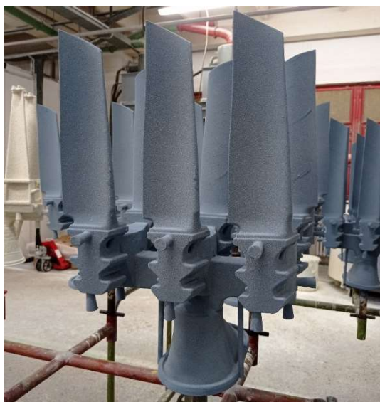
Obr. 21 Stromeček po počátečních obalech v břečce na vodní bázi
