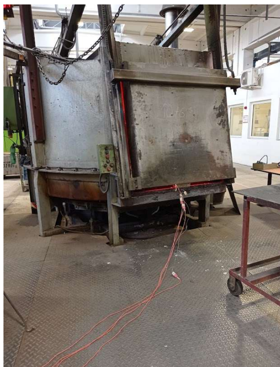
Obr. 27 Skořepina v předehřívací peci se zajištěnými vraty
