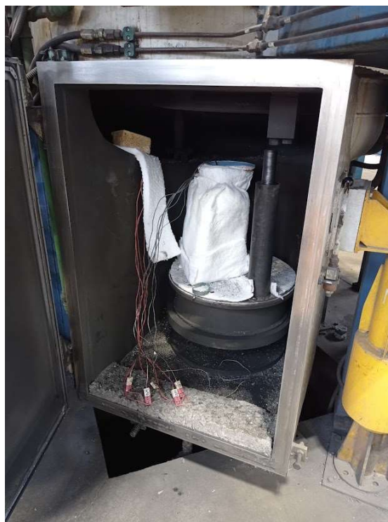
Obr. 47 Zapojení termočlánků v dolní komoře vakuové pece
