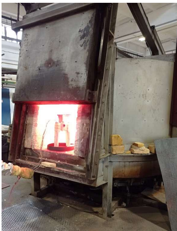
Obr. 26 Skořepina v předehřívací peci
