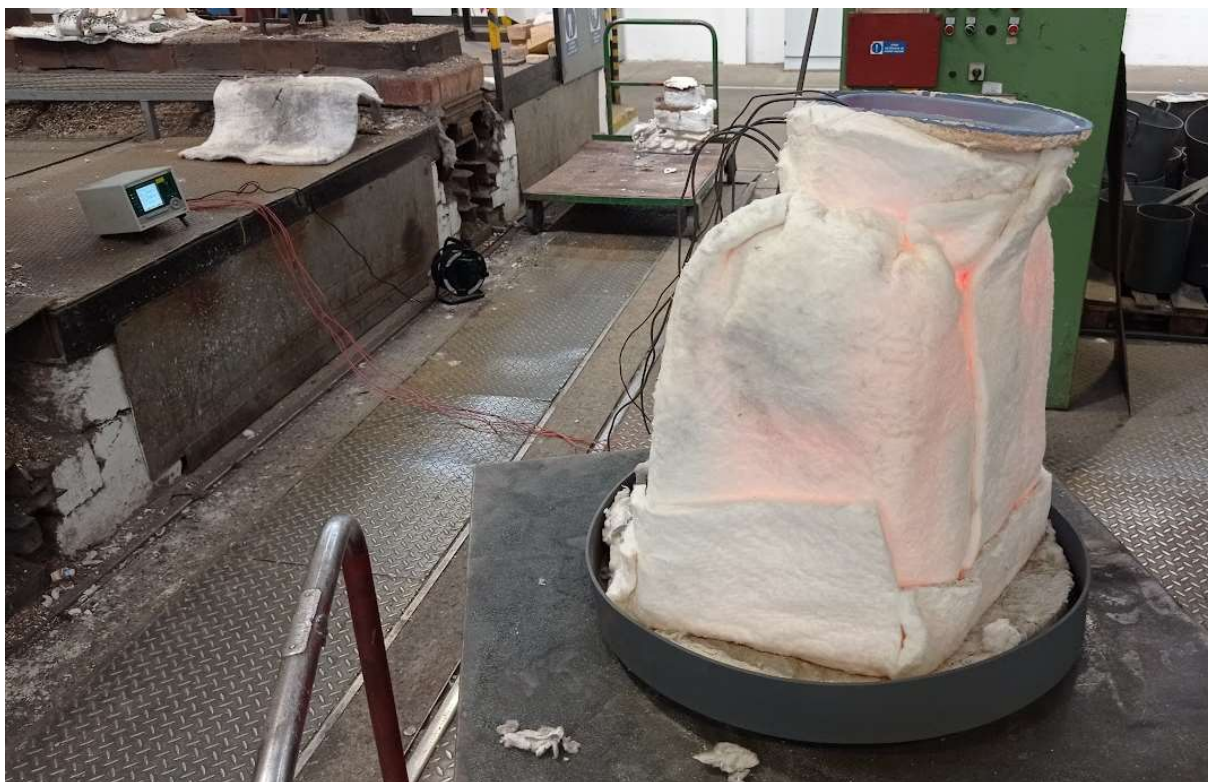
Obr. 51 Chladnoucí zabalená skořepina se zapojenými termočládky
