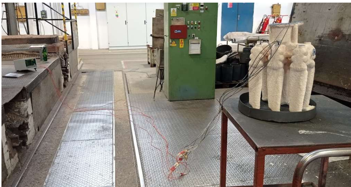
Obr. 28 Chladnoucí holá skořepina se zapojenými termočlánci
