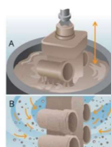
3. Výroba skořepin namáčením stromečku do keramické břechky
