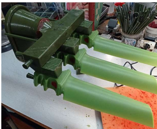
Obr. 19 Lepení voskových modelů lopatek na vtokovou soustavu
