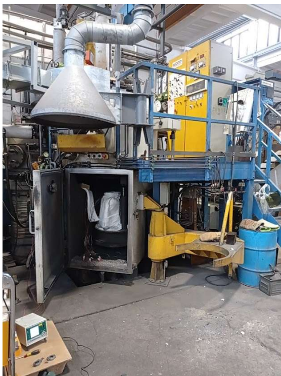
Obr. 46 Měření teplot v dolní komoře vakuové pece
