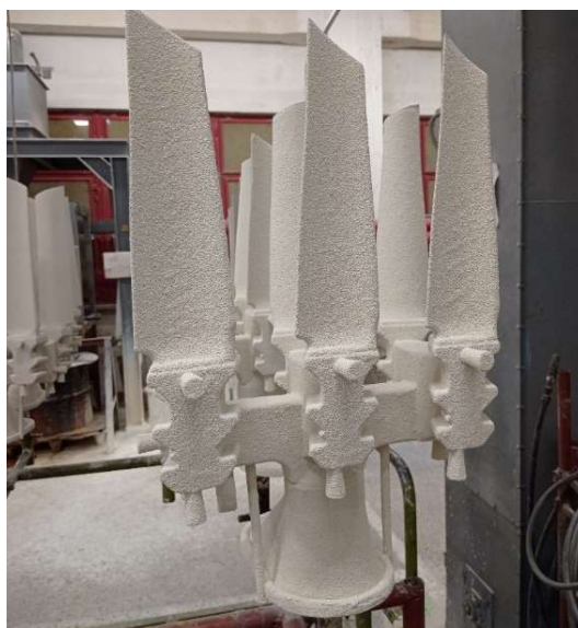
Obr. 22 Stromeček po obalu v břečce na alkoholové bázi
