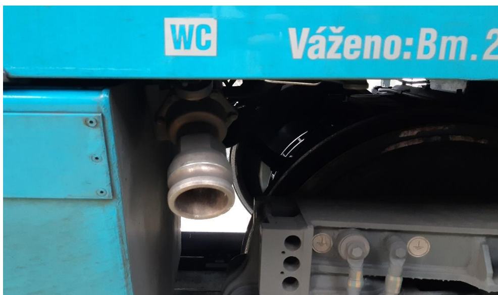
Obrázek 13 - podoba odsávacího ventilu uzavřeného systému WC jednotky řady 680, foto: František Vestfal, 04/2022
