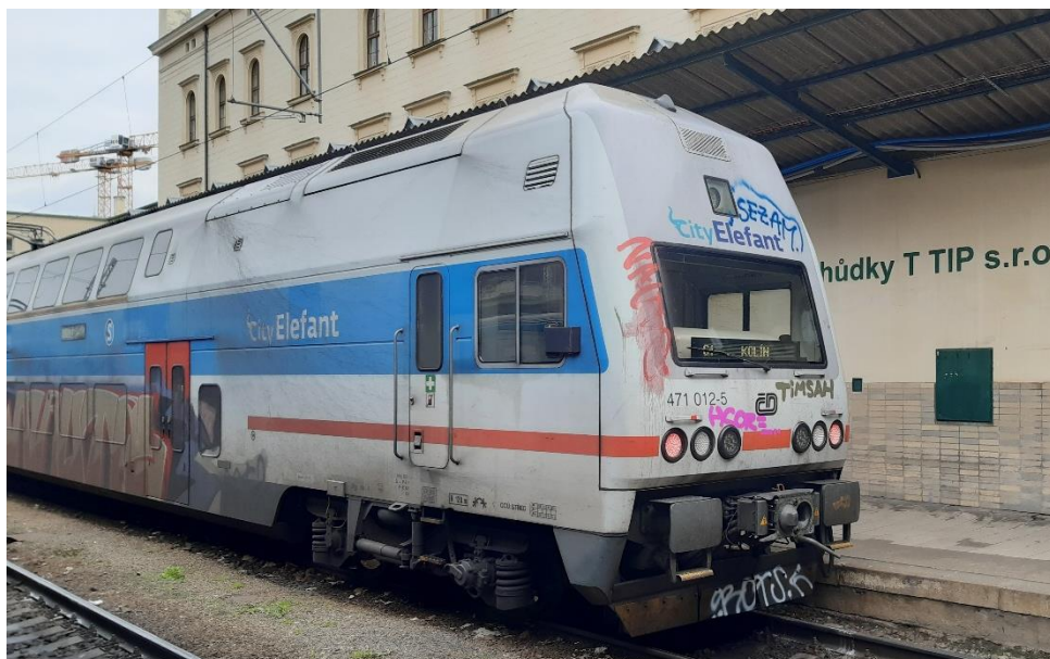
Obrázek 17 - ukázka poškození graffiti jednotky řady 471 ve stanici Praha-Masarykovo nádraží, foto: František Vestfal, 4/2022
