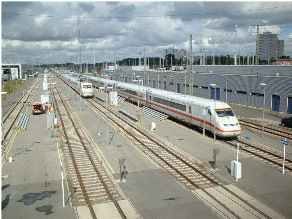
Obrázek 25 - sanitární koleje pro soupravy ICE ve stanici Berlin-Rummelsburg, autor: Marcus Meyer (2004)
