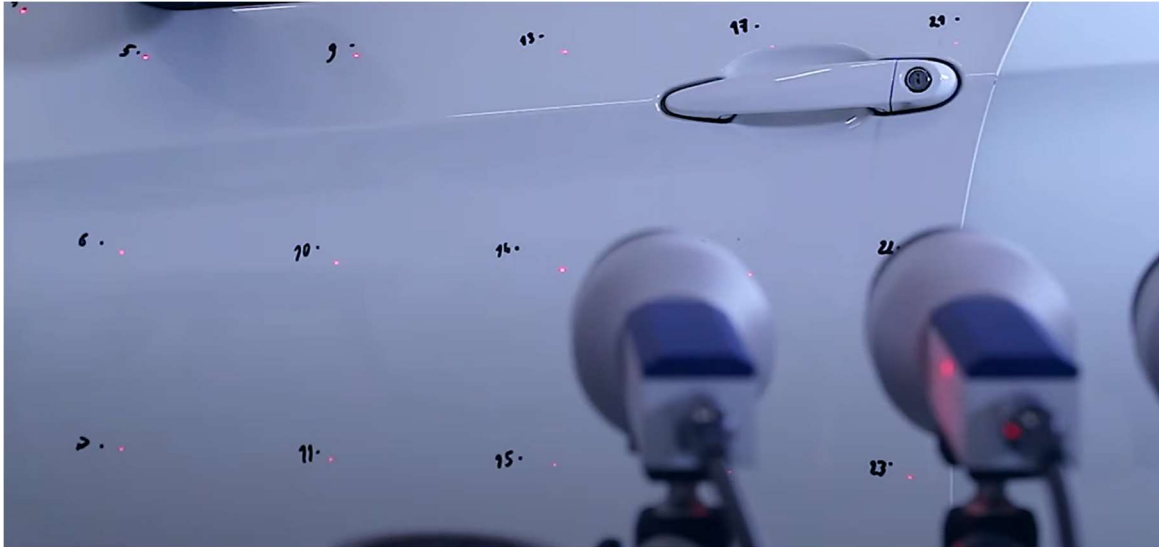
Obrázek 22: Měření NVH na dveřích automobilu, převzato z [14]
