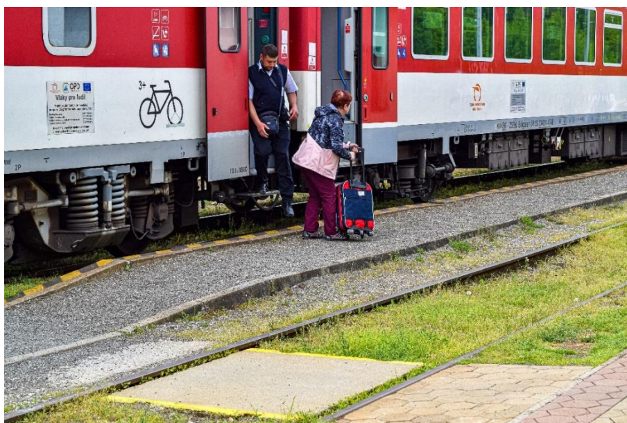
Obrázok 3 - Problémový výškový rozdiel nástupných schodíkov od úrovňových nástupíšť (zdroj: autor)
