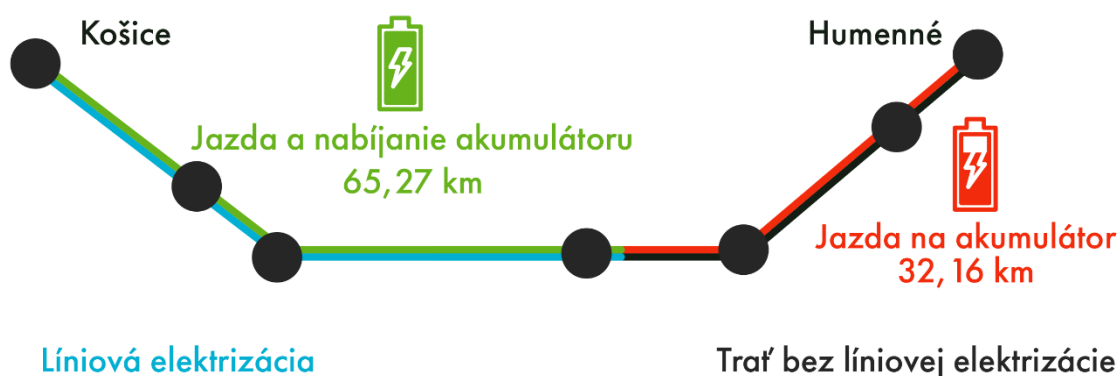
Obrázok 16 - Schéma konceptu prevádzky vozidla BEMU na riešenej trati (zdroj: vlastné spracovanie)
