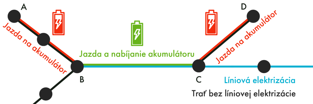
Obrázok 15 - Schéma možnosti využitia vozidla typu trolej/akumulátor (zdroj: vlastné spracovanie)
