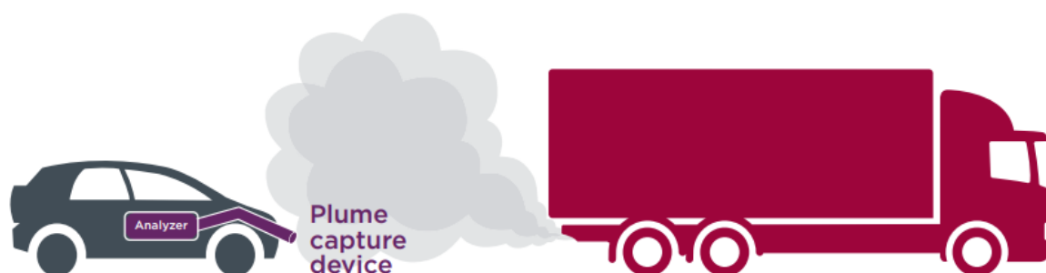
Obr. 10- Schéma použití „plume chasing“, kde „analyzer“ označuje měřící přístroje a „plume capture device“ označuje sběrné zařízení výfukových oblaků [9]
