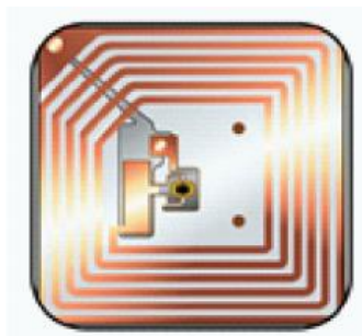
Obrázek 21: Vizualizace preferovaného – pasivního druhu RFID tagu
