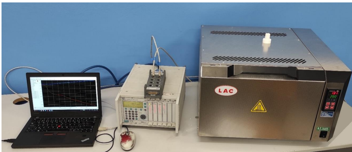
Obr. 18 – Zapojený Hardware pro ověření tenzometrů
