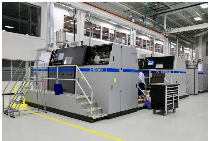
Obrázek 17: Tiskárna pro 3D tištěné palivové trysky na motor LEAP, převzato z:[55]
