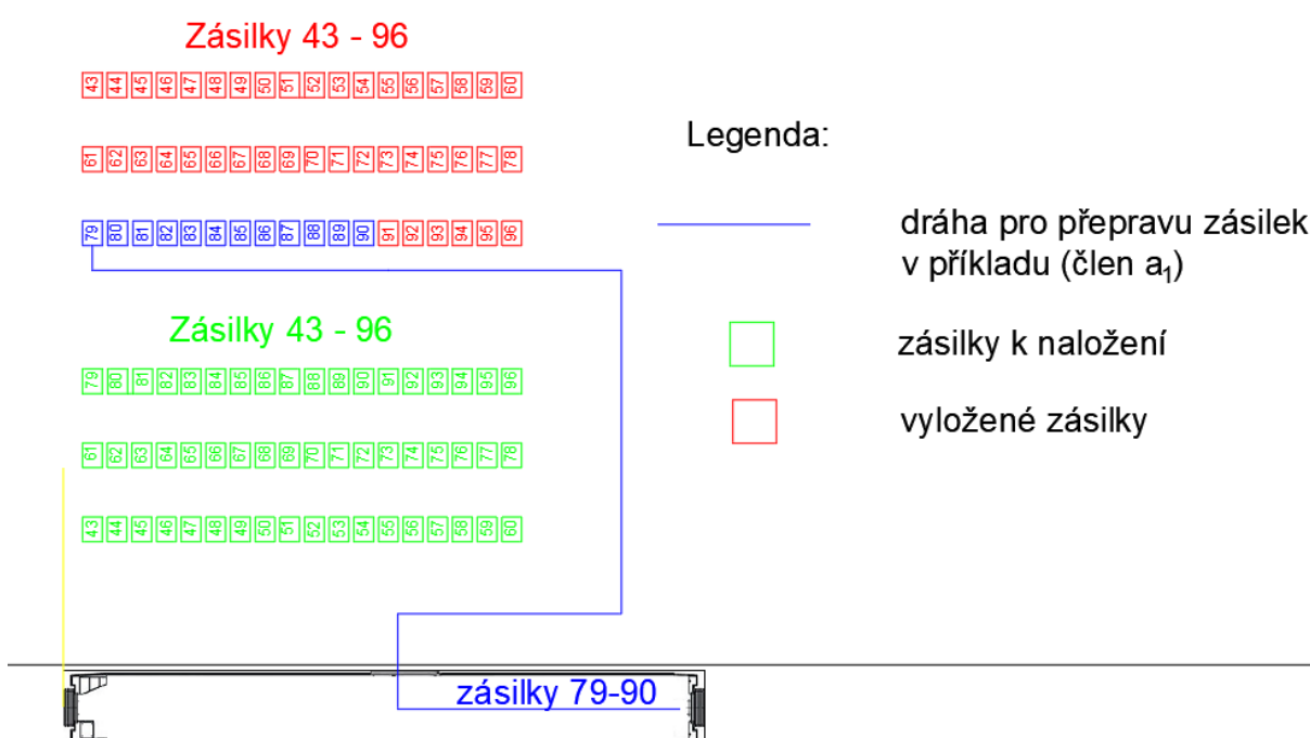
Obr. č. 23: Schéma zásilek a jejich dráha operující v příkladovém výpočtu na jednostranné nákladové rampě, zdroj: vlastní zpracování
