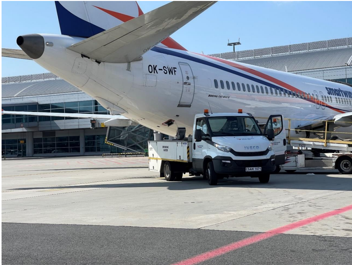
Obrázek 16 - servis pitné vody; [vlastní]
