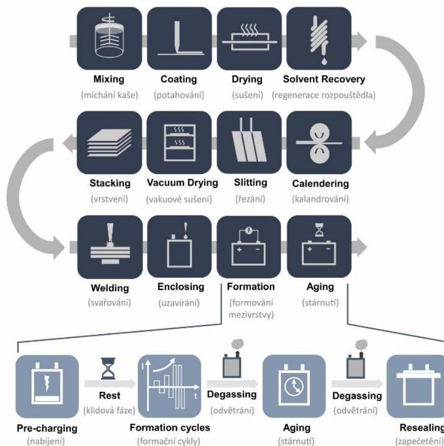
Obr. 9 - Schéma výrobního procesu Lithium-iontových baterií [12] - přeloženo
