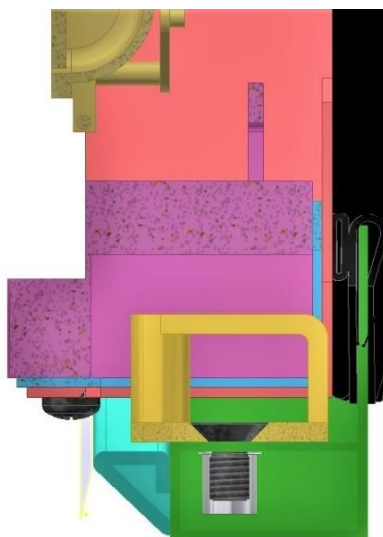
Obrázek 54: Řez zámkem dveří
