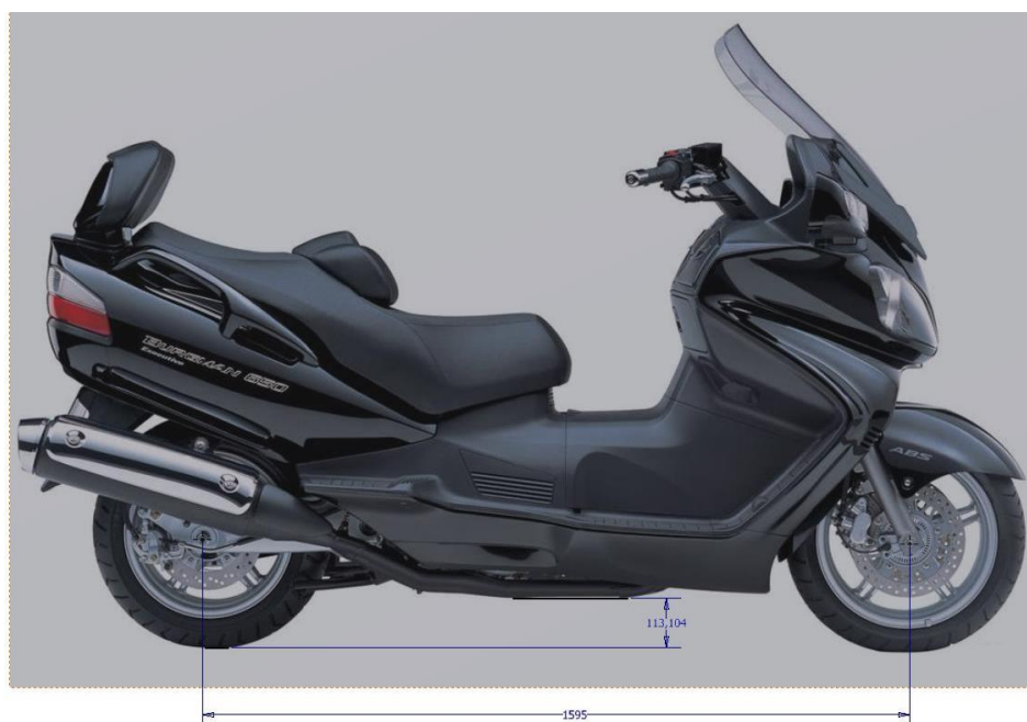
Obrázek 21: Světlá výška originálního skútru
