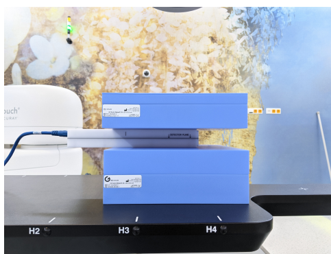
(b) Finální nastavení SMC s požadovanou tloušťkou vodě-ekvivalentních desek.
