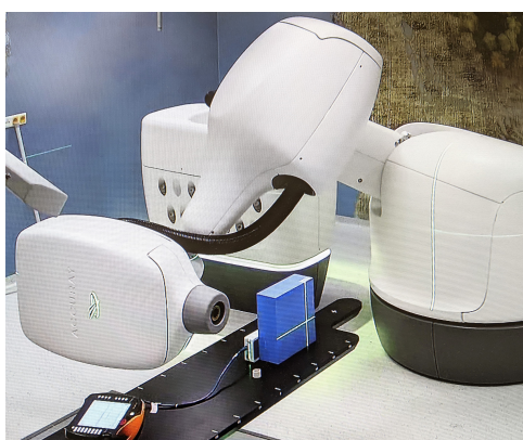
Obrázek 3.7: Nastavení SMC pro ozáření R-L geometrie při testu gravitačního efektu svazku.
