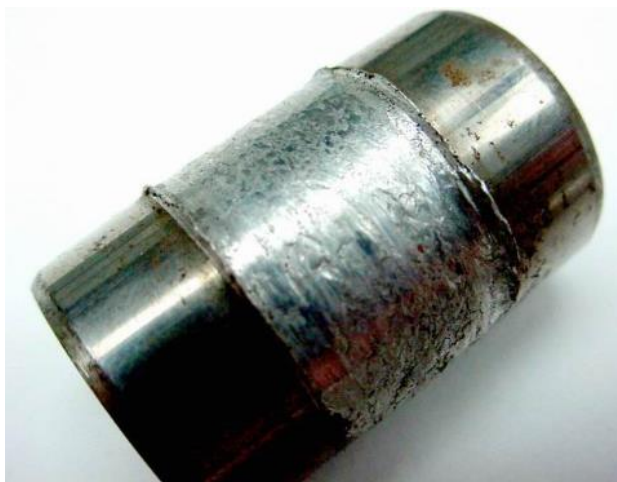
Obrázek 9 Adhezivní opotřebení na čepu [41]
