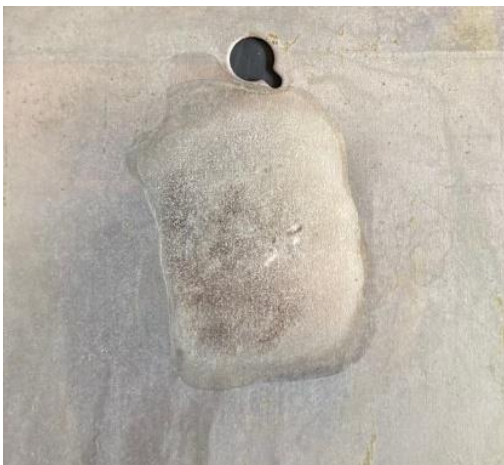
Příloha A.3 Nanesený povlak vysokorychlostním elektrolytem při U=7V , I=0,2A za 7 min
