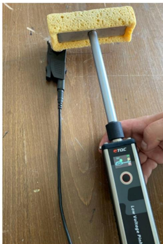
Obrázek 25 Testování pórovitosti na vzorcích pokovených vysokorychlostním elektrolytem
