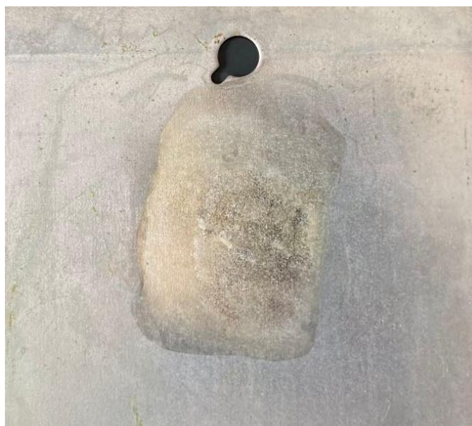
Obrázek 27 Nanesený povlak vysokorychlostním elektrolytem při U=7V a I=0,2A za 5 min
