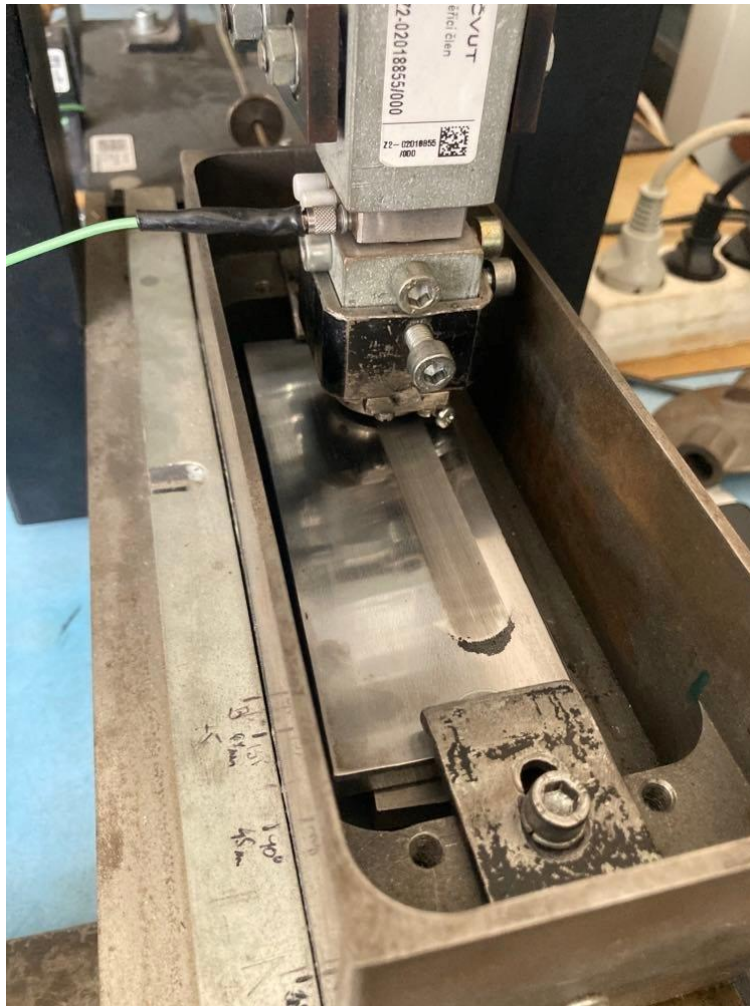
Obrázek 31 Dráha translačně oscilačního pohybu funkční dvojice po 30 minutách tribologického testování při zatížení 1 kg
