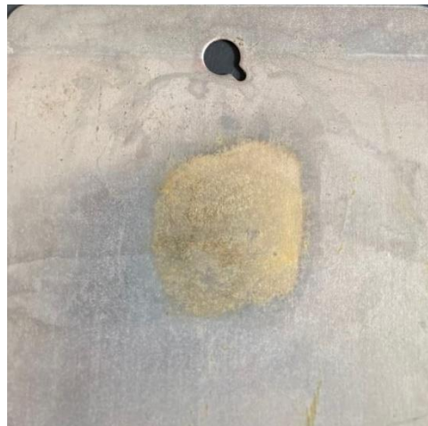
Příloha A.2 Nanesený povlak vysokorychlostním elektrolytem při U=7V , I=0,2A za 3 min
