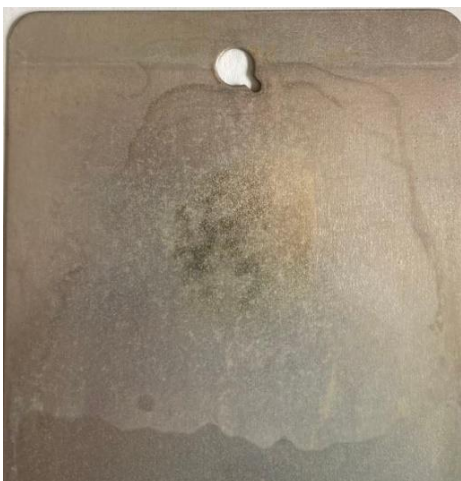
Příloha A.1 Nanesený povlak vysokorychlostním elektrolytem při U=7V , I=0,2A za 1min
