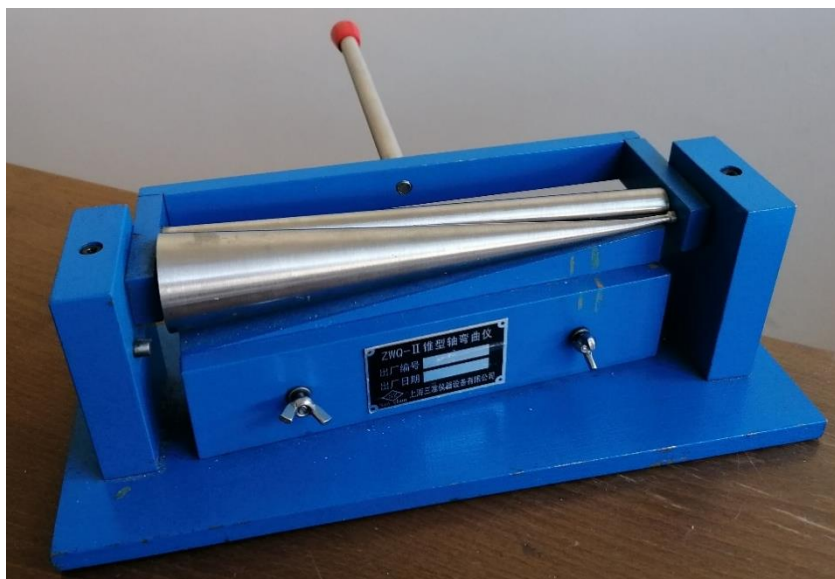
Obr. 26: Kónický trn pro ohybovou zkoušku podle normy ČSN EN ISO 6860 [foto autora práce]
