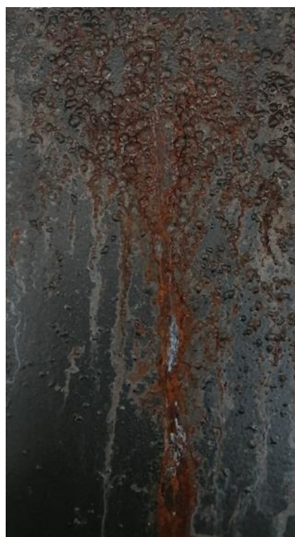
Obr. 44: Vzorek 3.12 po 1000 hodinách v neutrální solné mlze [foto autora práce]
