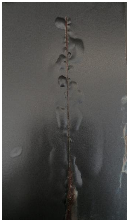
Obr. 46: Vzorek 2.13 po 1000 hodinách v neutrální solné mlze [foto autora práce]
