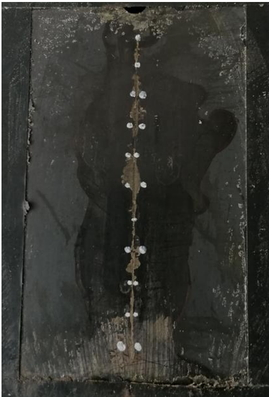
Obr. 49: Vzorek č. 1.13 pro hodnocení stupně podkorodování po 1000 hodinách v neutrální solné mlze [foto autora práce]
