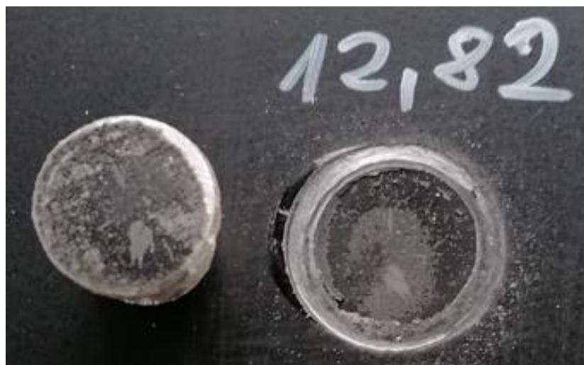
Obr. 41: Vzorek č. 2.7 po zkoušce odtrhem (odtrh č. 1) [foto autora práce]
