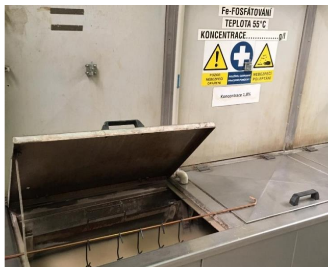
Obr. 22: Železité fosfátování ponorem ve firmě Doosan Bobcat EMEA, s.r.o. [foto autora práce]
