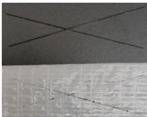
Obr. 35: Vzorek 2.6 po zkoušce křížovým řezem [foto autora práce]
