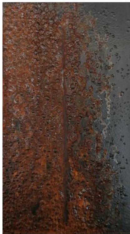
Obr. 45: Vzorek 3.13 po 1000 hodinách v neutrální solné mlze [foto autora práce]
