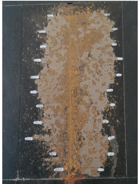
Obr. 47: Vzorek č. 3.10 pro hodnocení stupně delaminace po 480 hodinách v neutrální solné mlze [foto autora práce]
