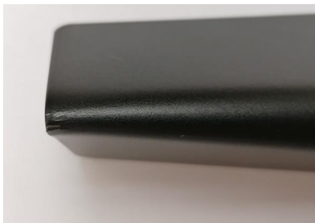
Obr. 28: Výsledek zkoušky ohybem u vzorku s železitým fosfátem (vzorek č. 2.1) [foto autora práce]
