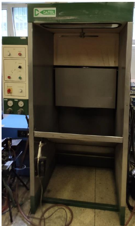
Obr. 24: Kabina pro elektrokinetické nanášení práškové barvy od firmy DATEL Ledec s.r.o. [foto autora práce]
