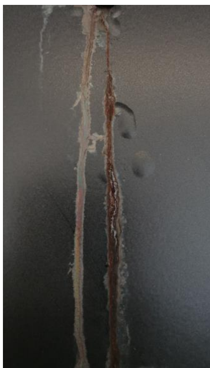
Obr. 43: Vzorek 1.13 po 1000 hodinách v neutrální solné mlze [foto autora práce]
