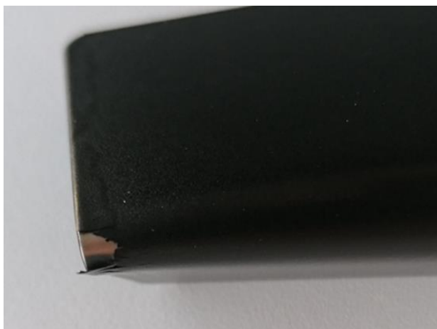
Obr. 27: Výsledek zkoušky ohybem u vzorku s nanopasivací na bázi zirkonu (vzorek č. 1.1) [foto autora práce]
