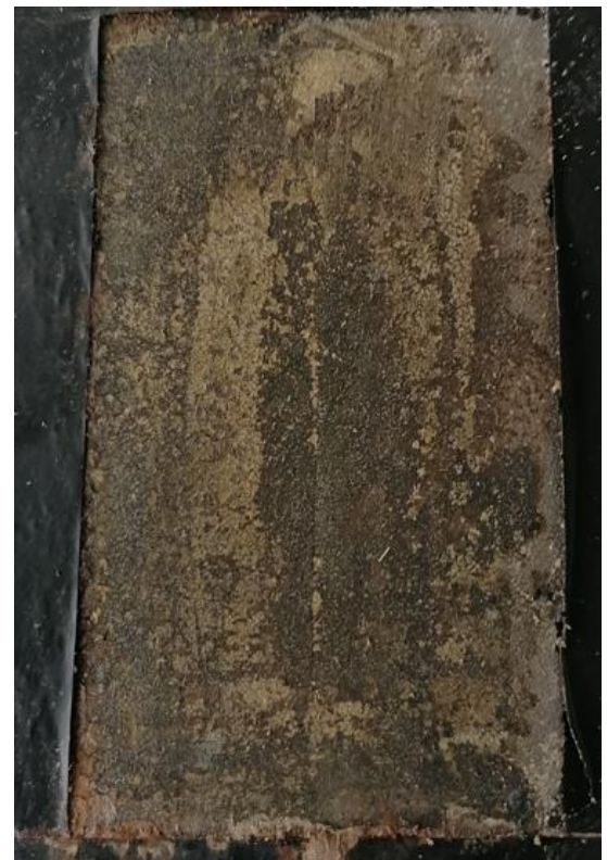
Obr. 50: Vzorek č. 3.13 pro hodnocení stupně podkorodování po 1000 hodinách v neutrální solné mlze [foto autora práce]
