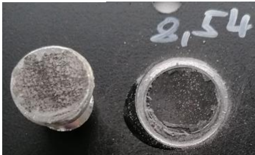
Obr. 40: Vzorek č. 3.7 po zkoušce odtrhem (odtrh č. 1) [foto autora práce]
