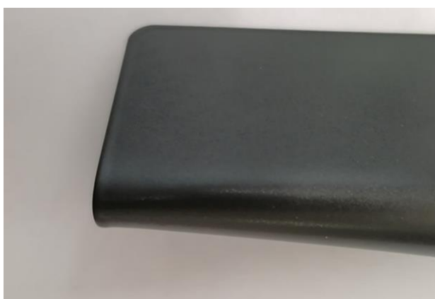
Obr. 29: Výsledek zkoušky ohybem u vzorku s tryskaným povrchem (vzorek č. 3.1) [foto autora práce]
