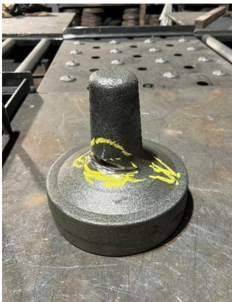
Obrázek č. 27 – Výkovek s vytvořenou přeložkou
