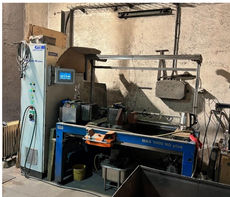
Obrázek č. 19 – Magnetická zkouška na stroji MAS 1000 HD
