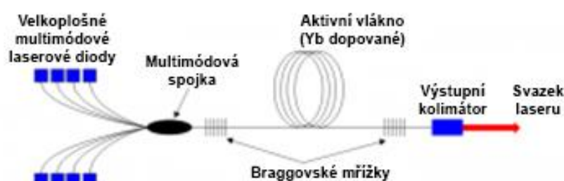
Obrázek 20 - Princip vláknového laseru [26]
