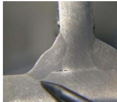
Obrázek 26 - Neprůvar kořene koutového svaru [33]
