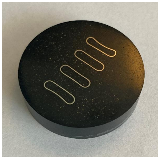
Obrázek 46 - Vyleštěný a vyleptaný výlisek se vzorky
