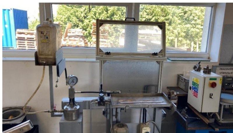
Obrázek 38 - Pracoviště pro provádění kontroly pevnosti svaru
