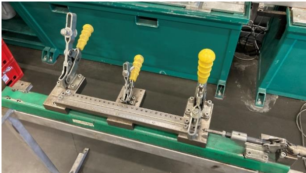
Obrázek 36 - Pracoviště pro přípravu vzorku na provedení tlakové kontroly pevnosti svaru
