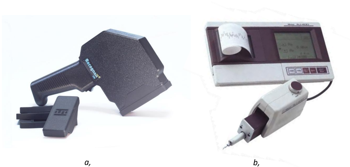
Obrázek 25 - měřící přístroje: a, Reconoil 2W; b, Mitutoyo z řady SJ
