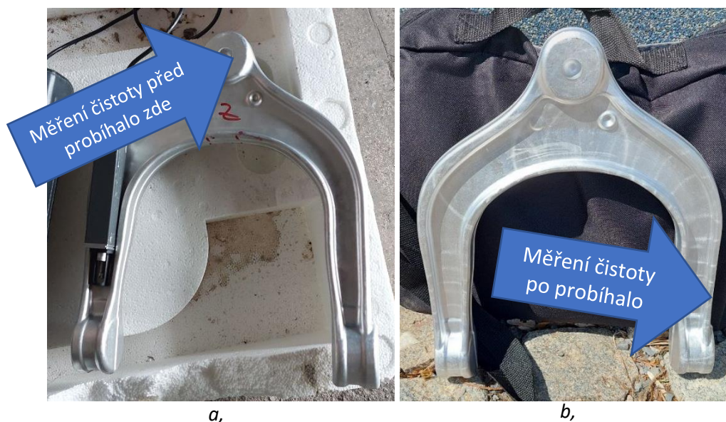
Obrázek 32 - podkova: a, před tryskáním, mořena; b, po tryskání UHPWJ
