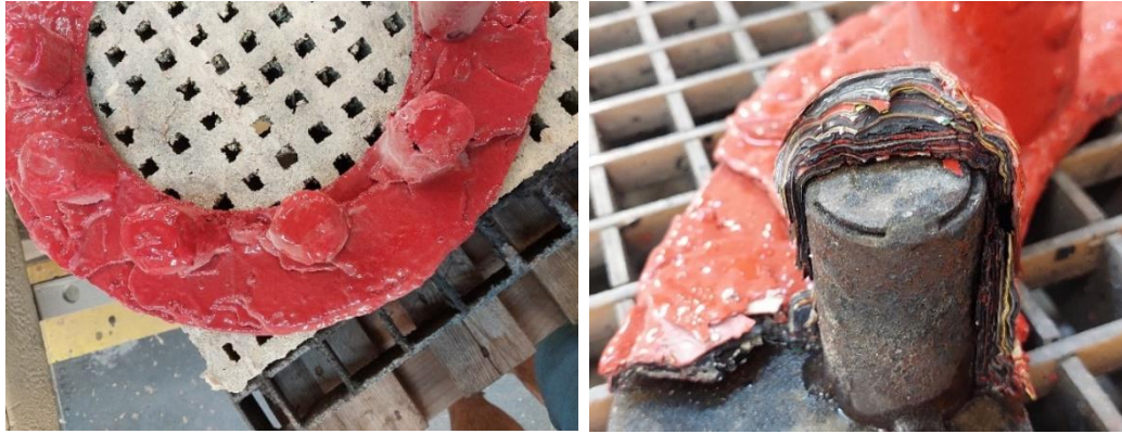
Obrázek 29 – vzorek 4: a, před čištěním; b, nánosy barvy po čištění
