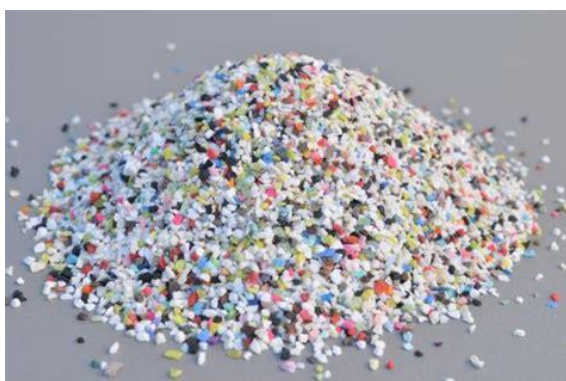
Obrázek 10 - tryskáci media: a, plastové abrazivo typu V; b, jedlá soda
