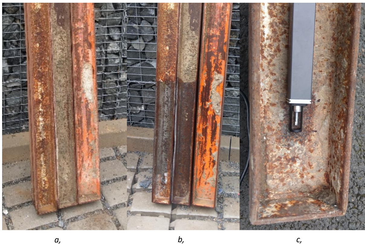
Obrázek 27 - vzorek 1; a, ocelový nosník před čištěním; b, nosník po čištění pomocí ultravysokotlaké vody; c, nosník po tryskání suchým ledem
