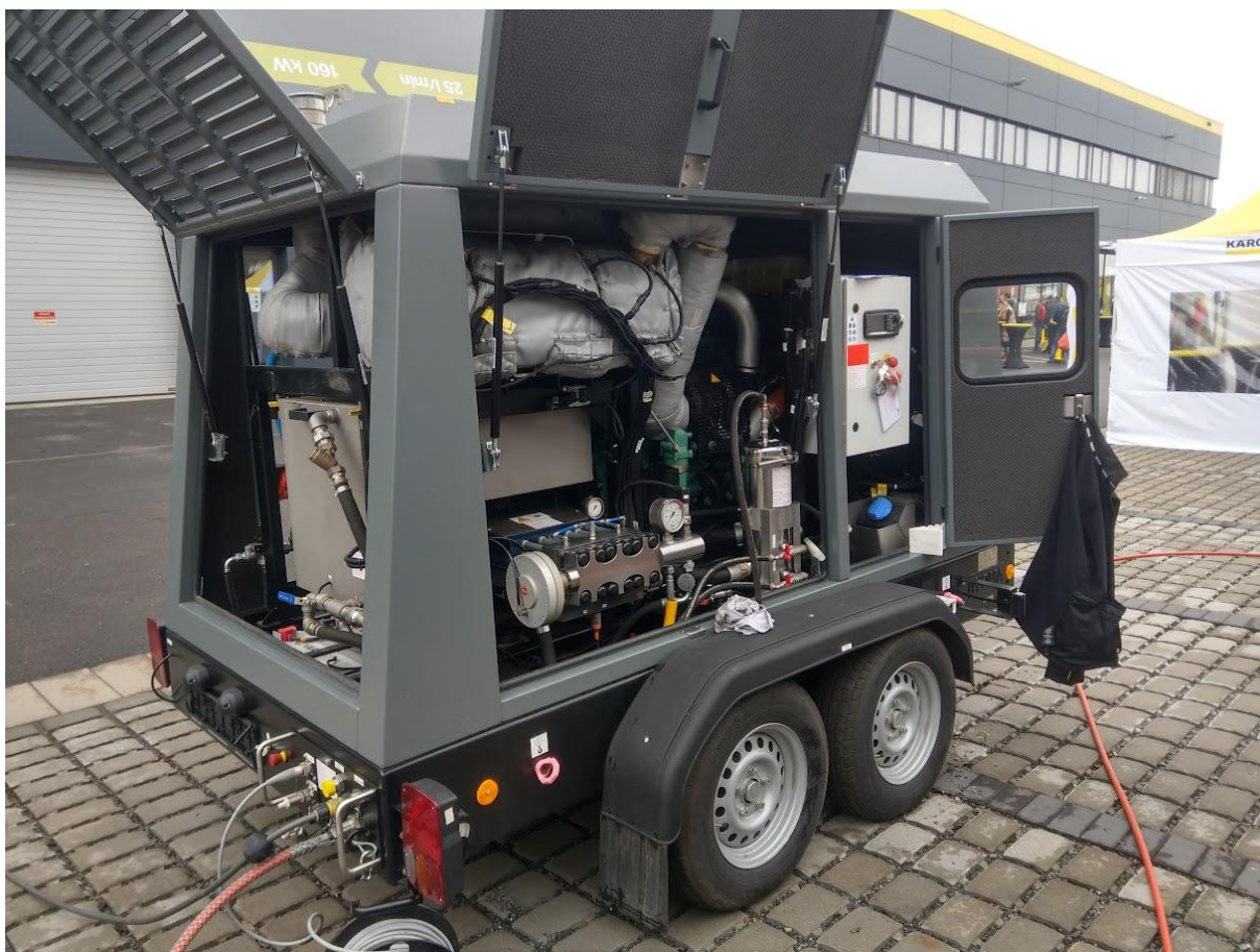
Obrázek 17 - stroj pro tryskání pomocí ultravysokotlaké vody
