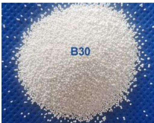
Obrázek 12 - tryskací media: a, keramické kuličky; b, drcené sklo
