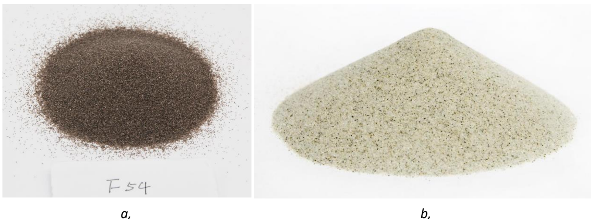
Obrázek 9 - tryskáci media: a, korundové abrazivo, oxid hlinitý 95%; b, křemičitý písek
