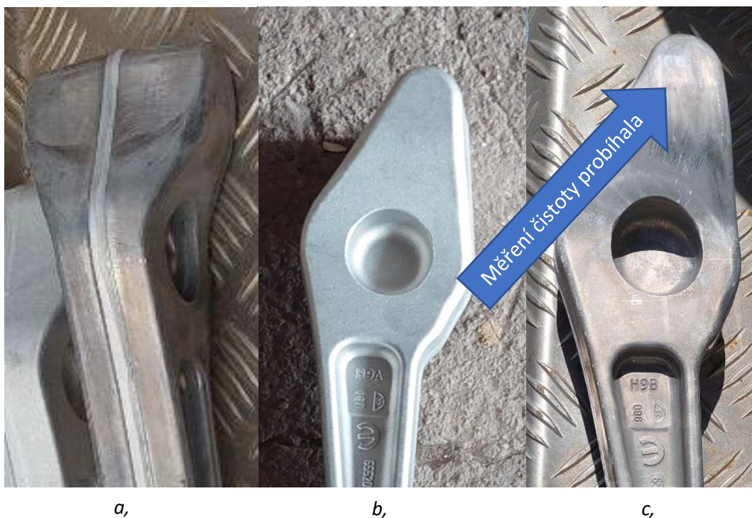
Obrázek 31 – vzorek 7: a, před čištěním; b, tryskán ocelovým drátem; c po tryskání ultravysokotlakou vodou
