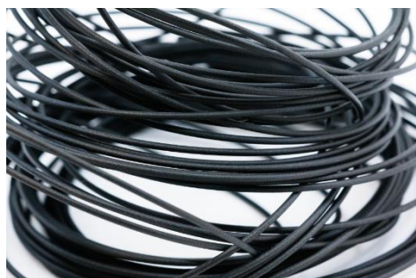
Obrázek 12 - filament s uhlíkovými vlákny [9]
