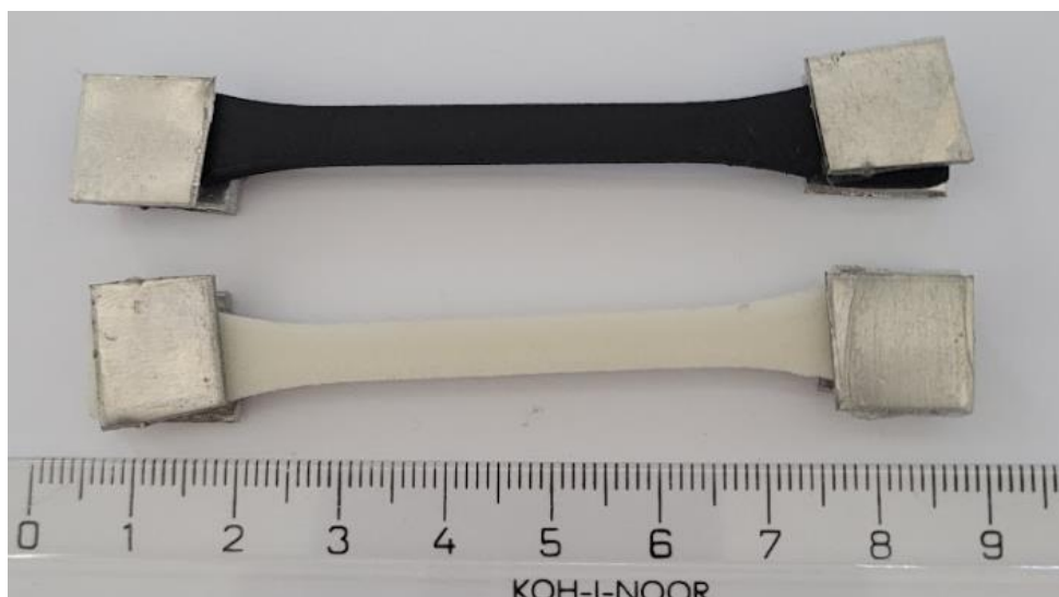
Obrázek 33 – vzorky připravené na tahovou zkoušku
