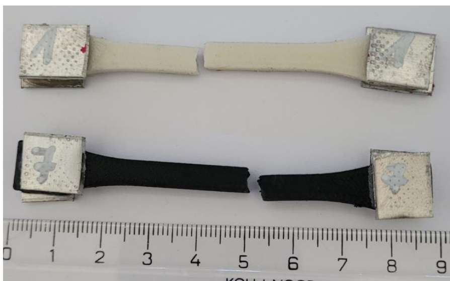
Obrázek 35 – přetržené vzorky po tahové zkoušce
