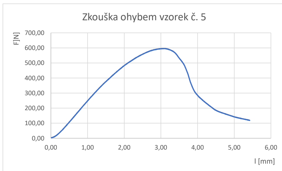
Obrázek 36 – diagram průběhu ohybové zkoušky
