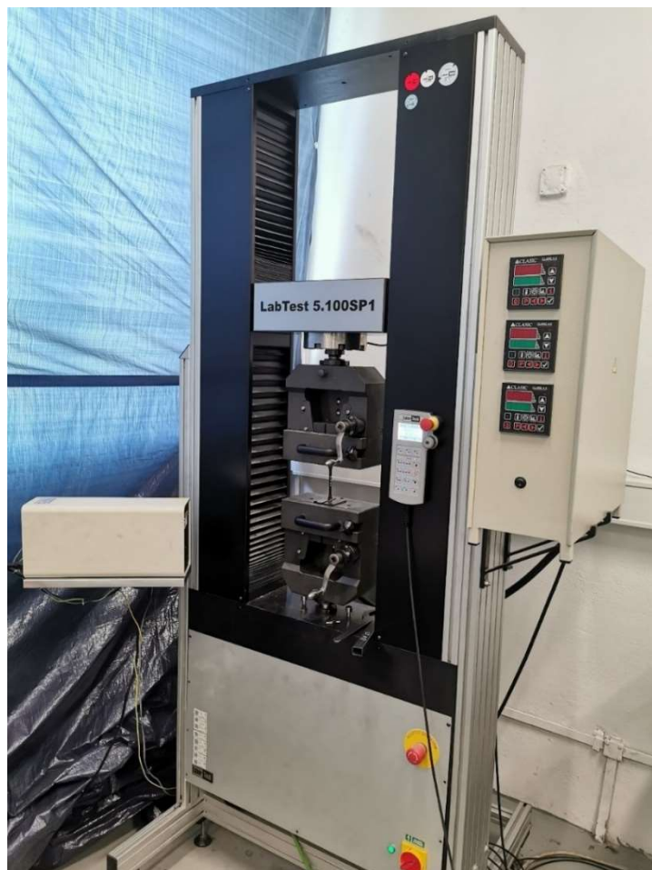
Obrázek 26: Zařízení LabTest 5.100SP1 určené na vykonání tahové zkoušky
