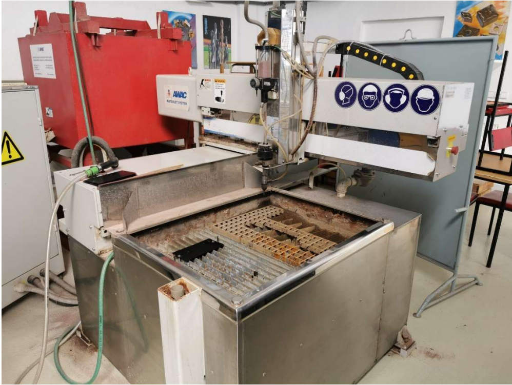
Obrázek 22: Zařízení AW – CT 0806 na řezání vodním paprskem
