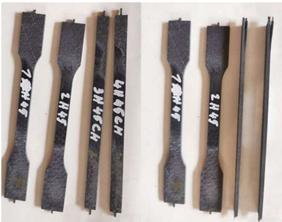
Obrázek 24: Delaminace vzorků způsobená řezáním vodním paprskem
