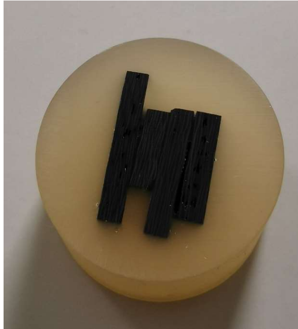
Obrázek 29: Vzorok zalité akrylátovou pryskyřicí
