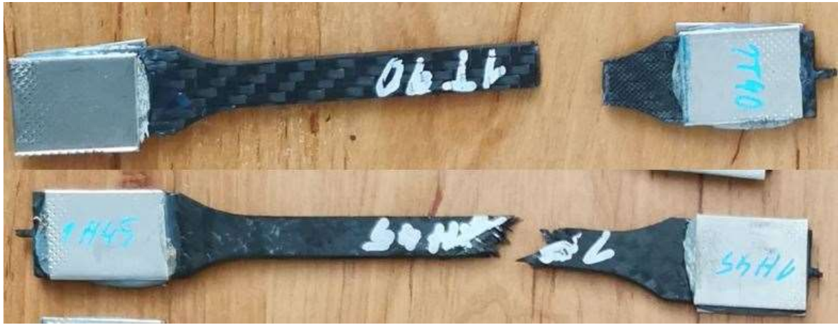
Obrázek 27: Roztrhané vzorky 45° a 90°
