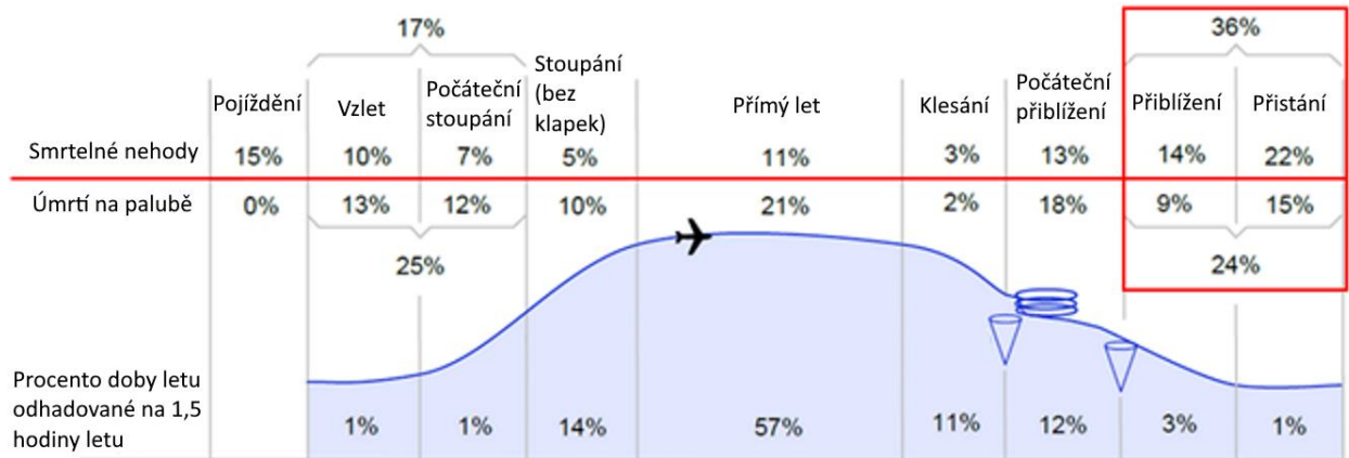
Obrázek 25 - Procento smrtelných nehod a úmrtí na palubě - komerční proudová flotila 2001 - 2010 (Boeing) (volný překlad) [23]
