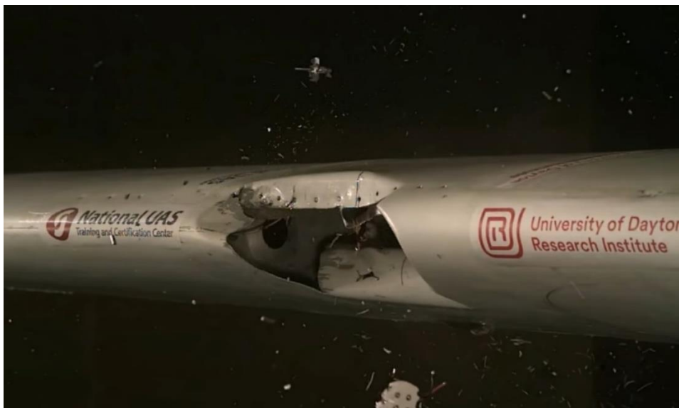
Obrázek 1 - Poškození křídla letounu všeobecného letectví rekreačním bezpilotním letadlem [18]
