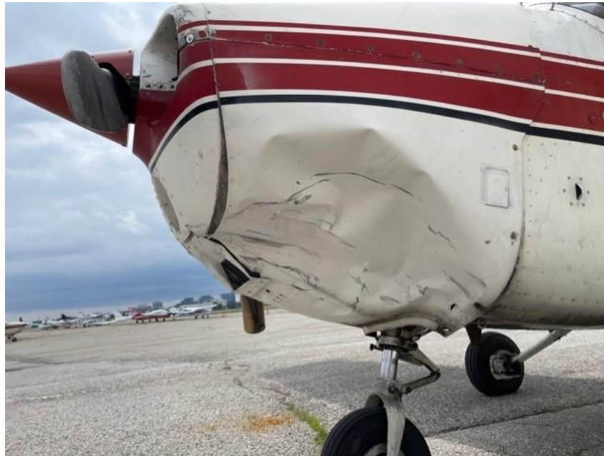
Obrázek 2 - Poškození letounu C172 [20]
