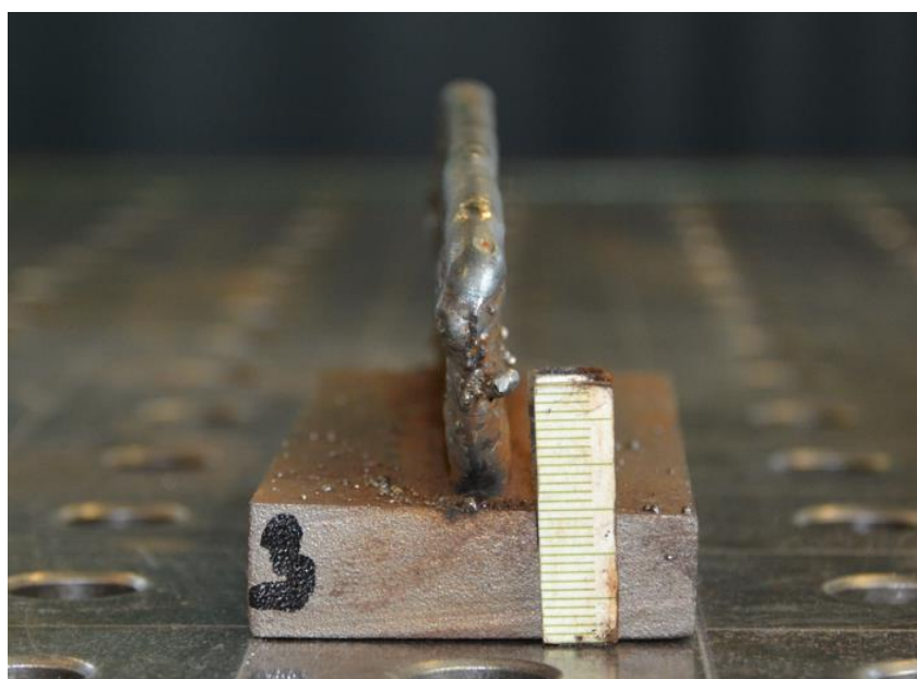
Obrázek 41 Profil vzorku vyrobeného metodou CMT-P
