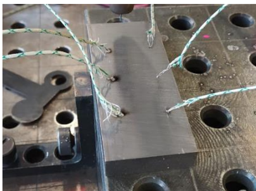
Obrázek 20 fotografie rozložení termočlánků
