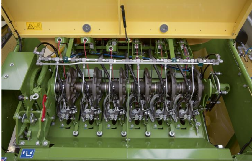
Obr. 15.: Vázací ústrojí BIG PACK KRONE [17]
