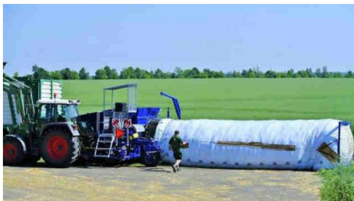
Obr. 14.: Bubnový lis pro ukládání píce do vaku [15]
