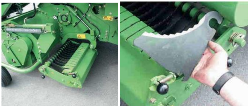
Obr. 7.: Řezací ústrojí – Nosník s řezacími noži
