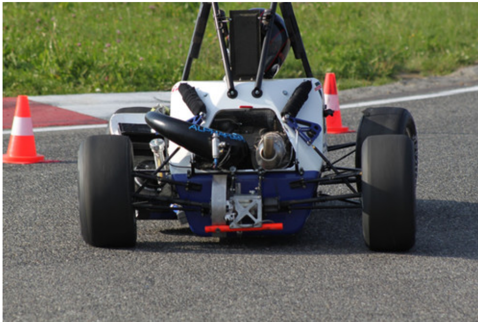
Obr. 3: Výrazná změna odklonu levého (vnějšího) kola při průjezdu zatáčkou [3]
