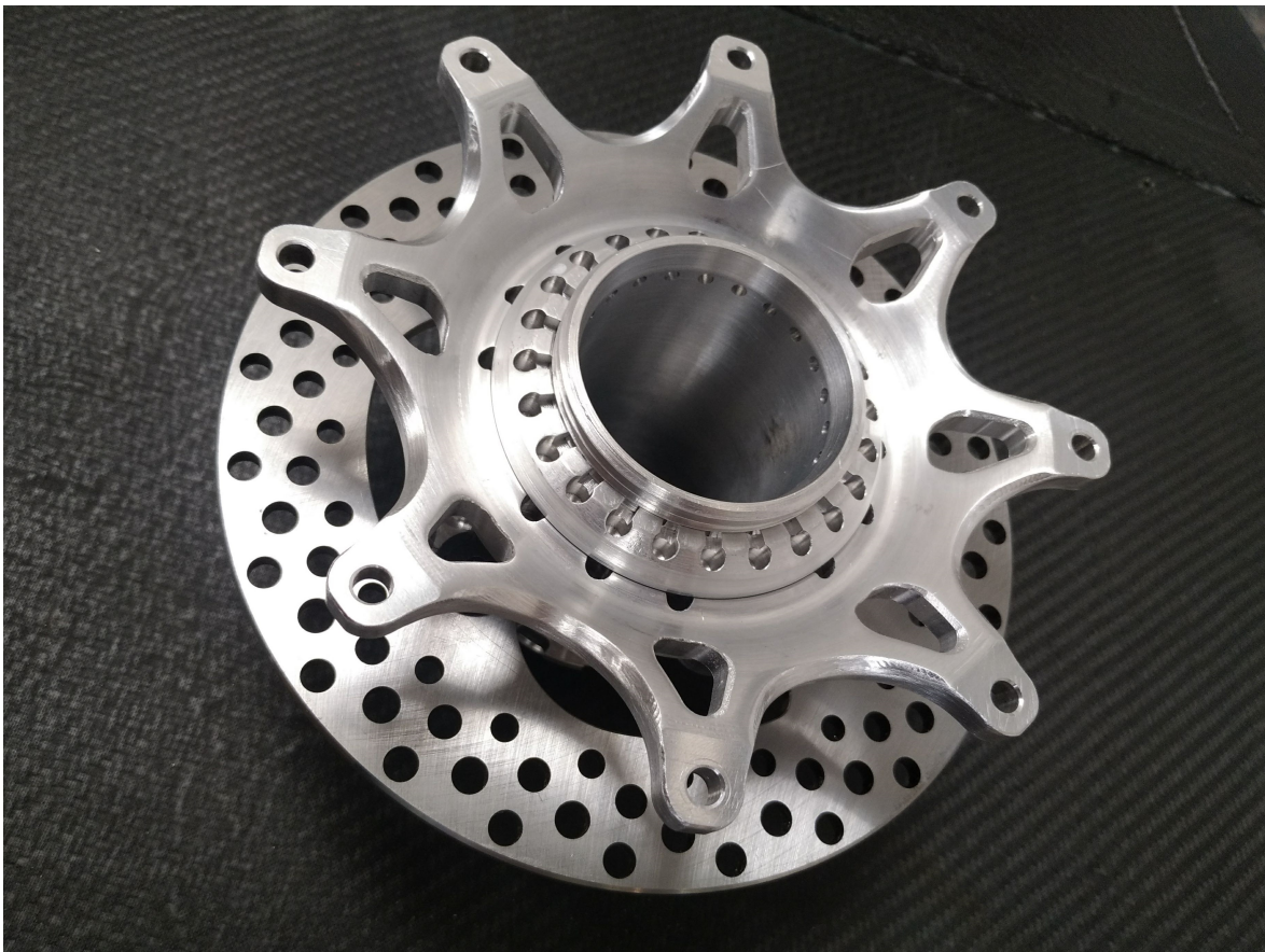
Obr. 51: Sestavené komponenty přední kolové skupiny před eloxováním
