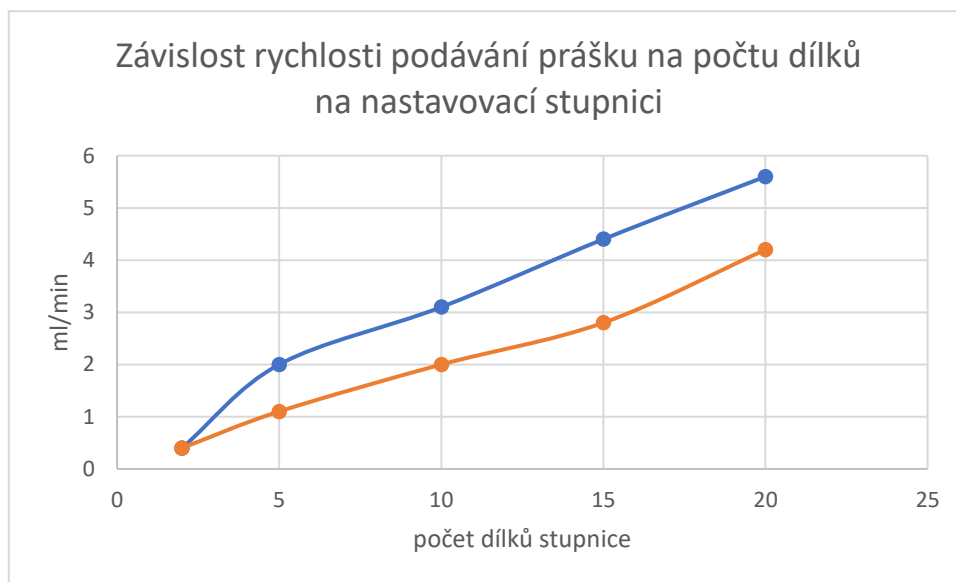
Obrázek 9: Graf závislosti rychlosti podávání prášku na počtu dílků na nastavovací stupnici
