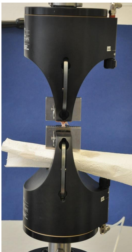
Obrázek 34 – Upnutí vzorku do pneumatických čelistí
