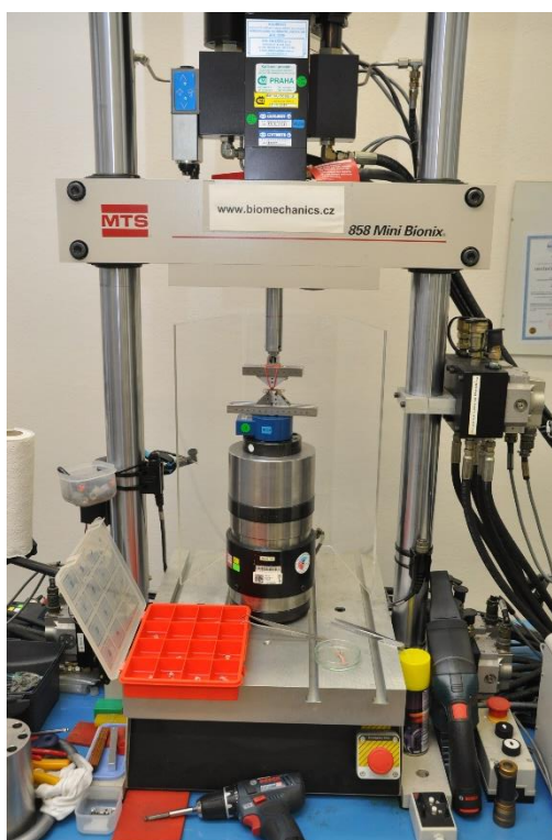
Obrázek 18 – Systém MTS Mini Bionix 858.02 se speciálním přípravkem
