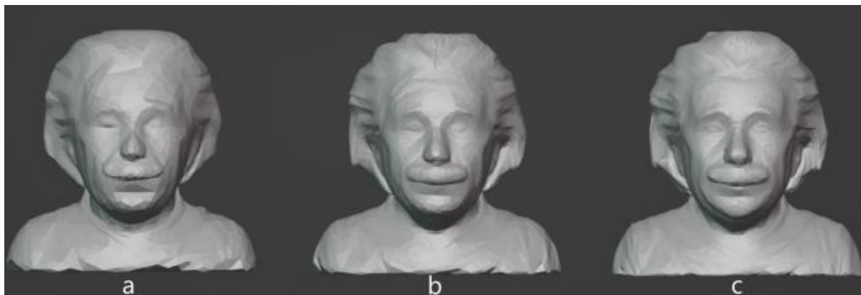
Obrázek 30-Porovnání skenů z mého skeneru s různým nastavením úhlového a výškového kroku. A) úhl. krok 5 stupňů, výškový krok 3 mm, B) úhl. krok 3 stupně, výškový krok 2 mm, A) úhl. krok 1 stupeň, výškový krok 1 mm.
