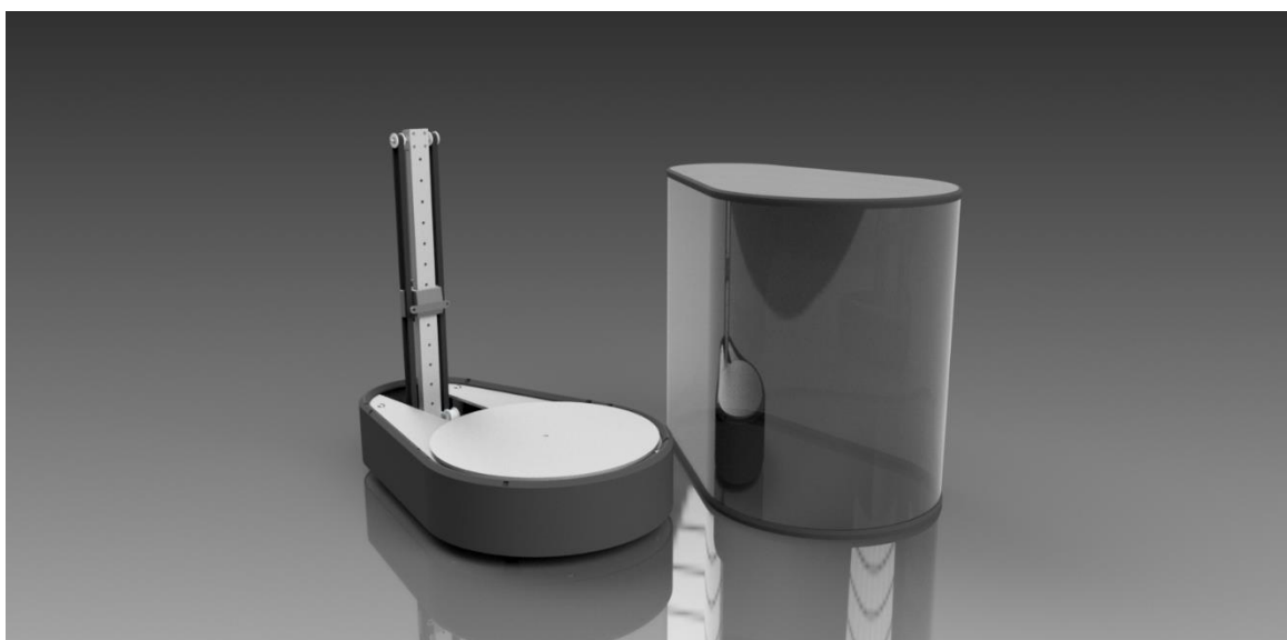
Obrázek 27-Render finálního návrhu skeneru bez krytu v programu Inventor
