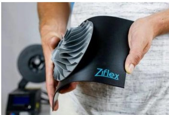
Obrázek 15: Snímání výtisku pomocí ohýbání pružné odnímatelné tiskové podložky [14]
