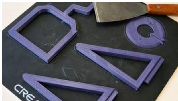
Obrázek 14: Snímání hotových výtisků škrabkou [14]
