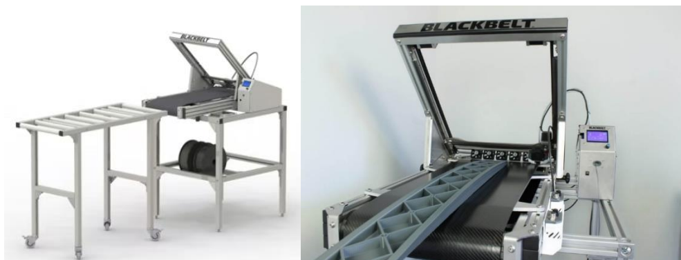
Obrázek 22: BLACKBELT 3D printer s válečkovým dopravníkem a ukázka tisku výrobku s velkým rozměrem v ose Z [18] [19]
