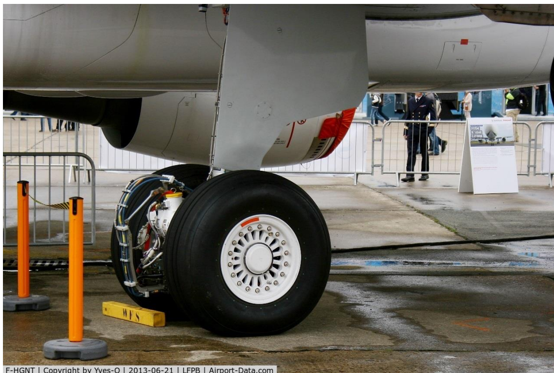
Obrázek 4: Systém EGTS instalovaný na hlavním podvozku letadla Airbus A320 [17]
