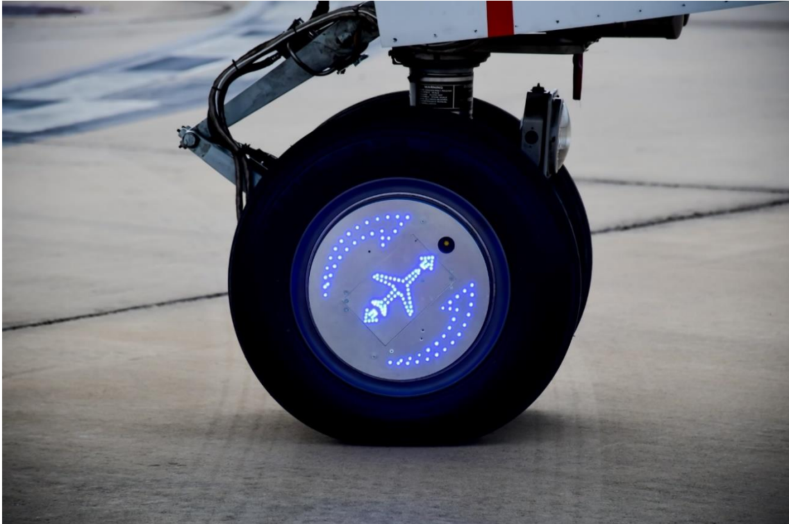
Obrázek 2: Systém WheelTug instalovaný v předovém podvozku letadla [14]
