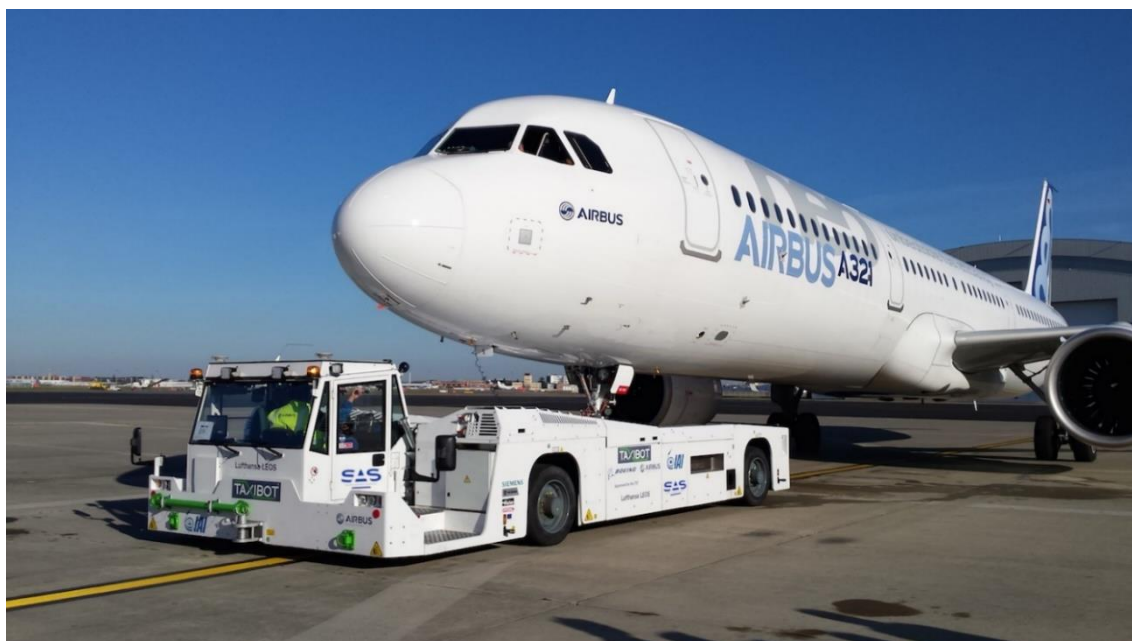
Obrázek 5: TaxiBot (NB) táhnoucí letadlo Airbus A321 [21]
