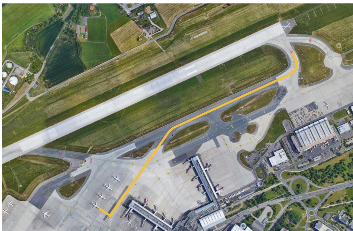
Obrázek 13: Mapa trasy poježdění letadla k dráze 24 – vzdálenost 1157 m [16]
