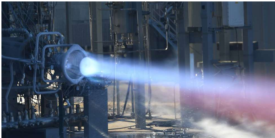
Obrázek 22 Test raketového motoru s tištěnými součástkami (NASA, 2020)
