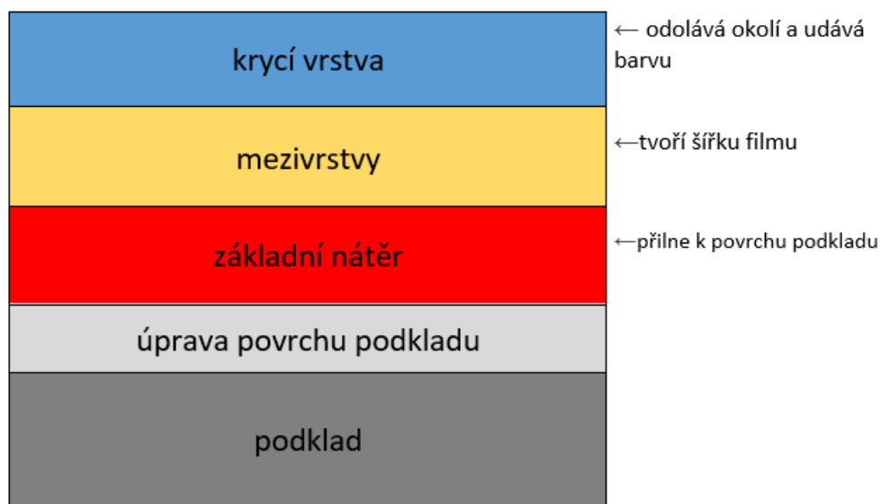
Obrázek 9 Struktura povrchu nátěrové hmoty [14]
