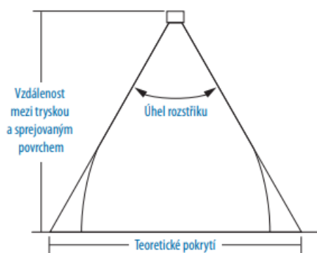
Obrázek 15 Schéma rozstříku a teoretického pokrytí v závislosti na vzdálenosti mezi tryskou a povrchem [25]
