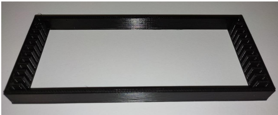
Obrázek 29 Přípravek zhotoven 3D tiskem od firmy TECHTEST
