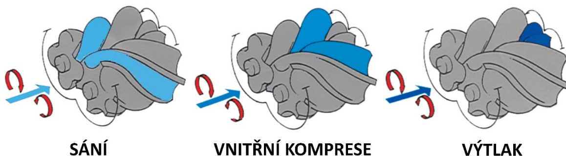
Obr. 7 – Pracovní fáze šroubového kompresoru [10]
