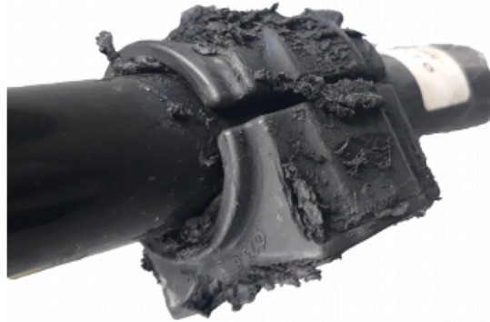
Obrázek 79: Příklad opotřebení pryžového silentbloku po životnostním měření
