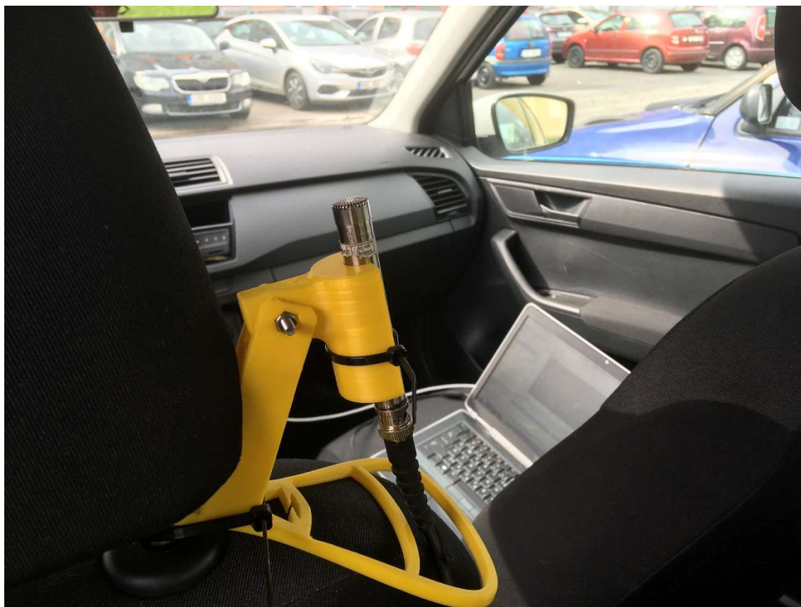
Obr. 21 Upevnění mikrofónu ve Škodě Fabia třetí generace
