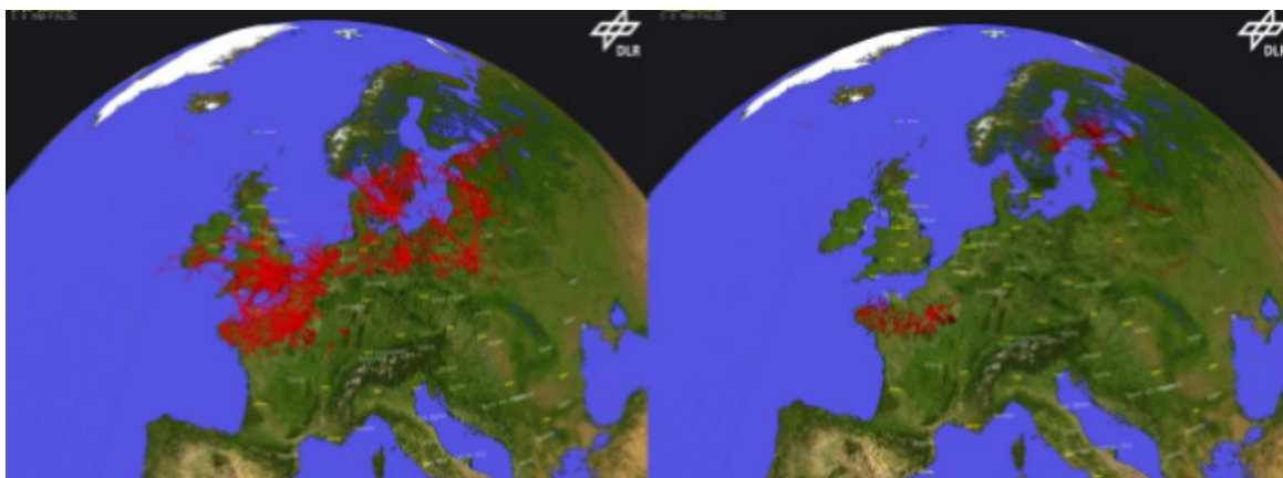
Obr. 16 Polohy stretu lietadla so sopečným popolom v prvý deň simulácie ( vľavo) a druhý deň (vpravo) [36]
