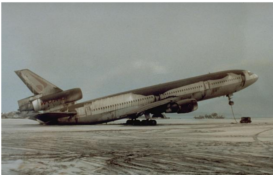
Obr. 3 : Usadený sopečný popol na lietadle DC-10 počas sopečnej erupcie v roku 1991 [7]
