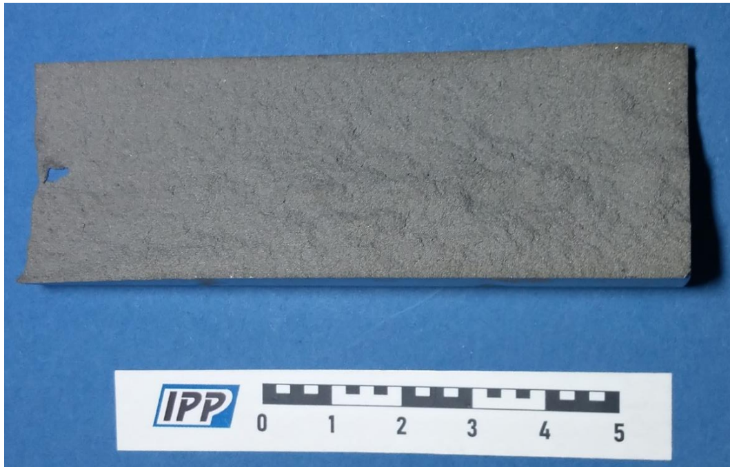
Obrázek 14 – Nástřík Ti6Al4V metodou CS.
