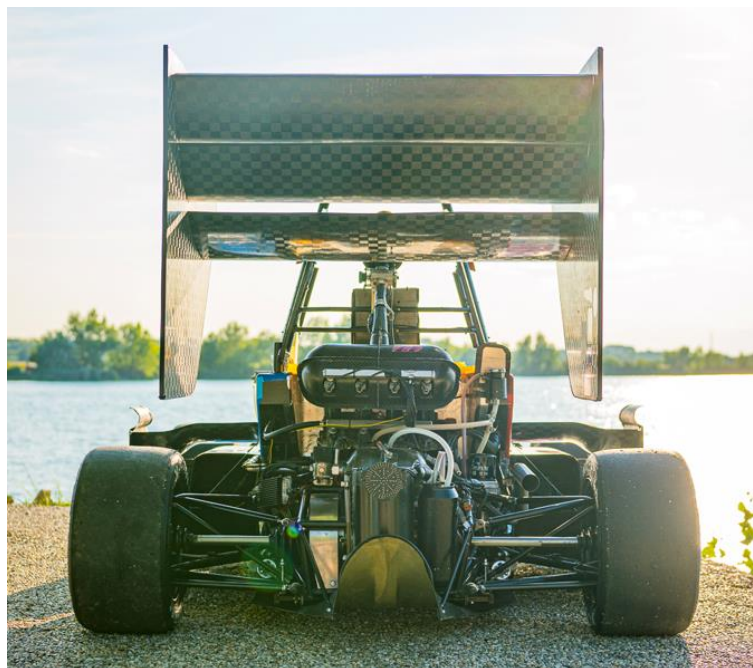
Obr. 9 sací trakt s nasáváním vzduchu nad hlavou řidiče [16]
