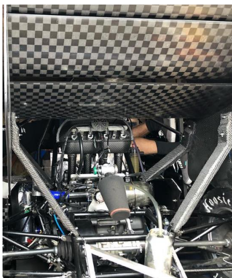
Obr. 11 Sací trakt umístěn v dolní části za motorem [16]
