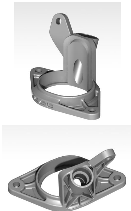
Obr.43 Příruby kotvící sací systém k hlavě motoru sloužící i jako držáky vstřikovačů
