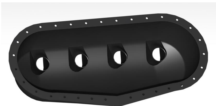
Obr.41 Horní část sacího pléna s kapsami pro vstřikovače
