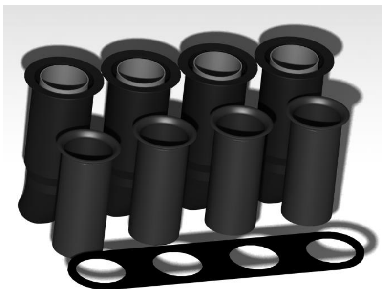
Obr.38 Komponenty sestavy runnerů
