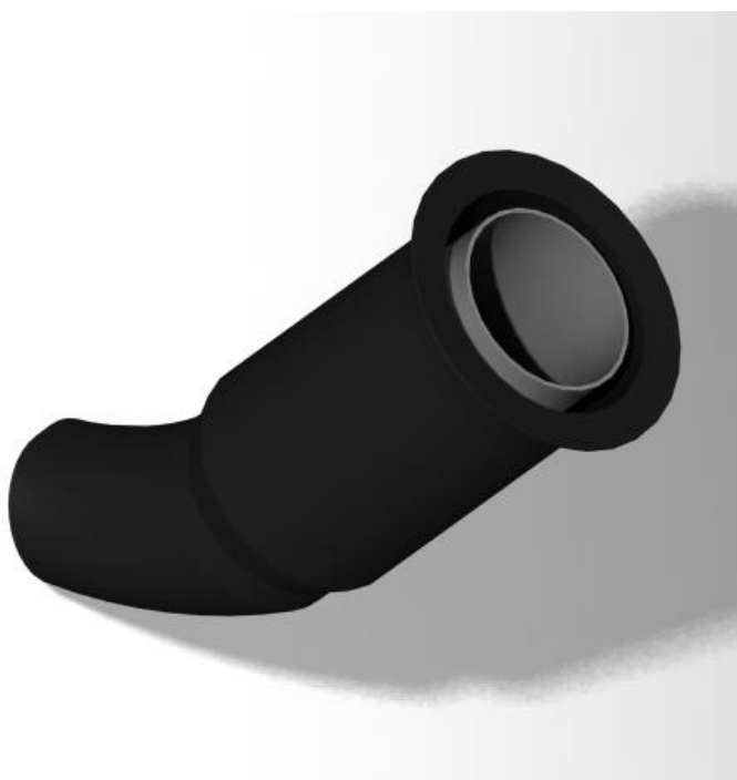
Obr.37 Plášť runneru s hliníkovou vložkou
