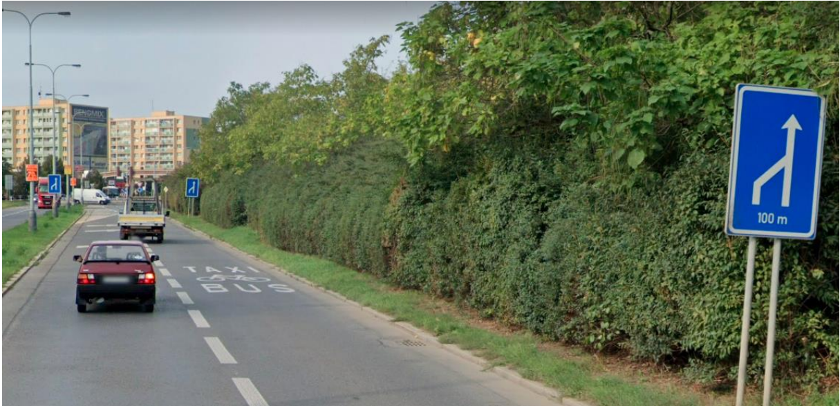
Obr. 14 Snížení počtu jízdních pruhů na čtyřpruhové směrově rozdělené komunikaci před okružní křižovatkou s jedním pruhem na okruhu [GoogleMaps]
