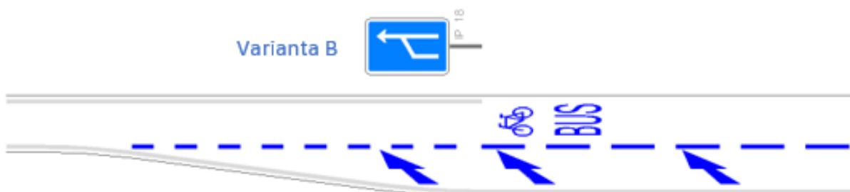
Obr. 17 Situace č. 1 – Ukončení VJP snížením počtu jízdních pruhů – Varianta B [17]
