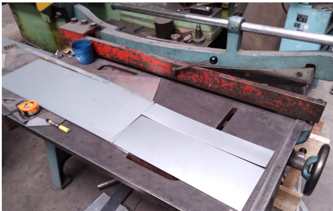
Obrázek 5: Materiál 6063 pro první experiment
