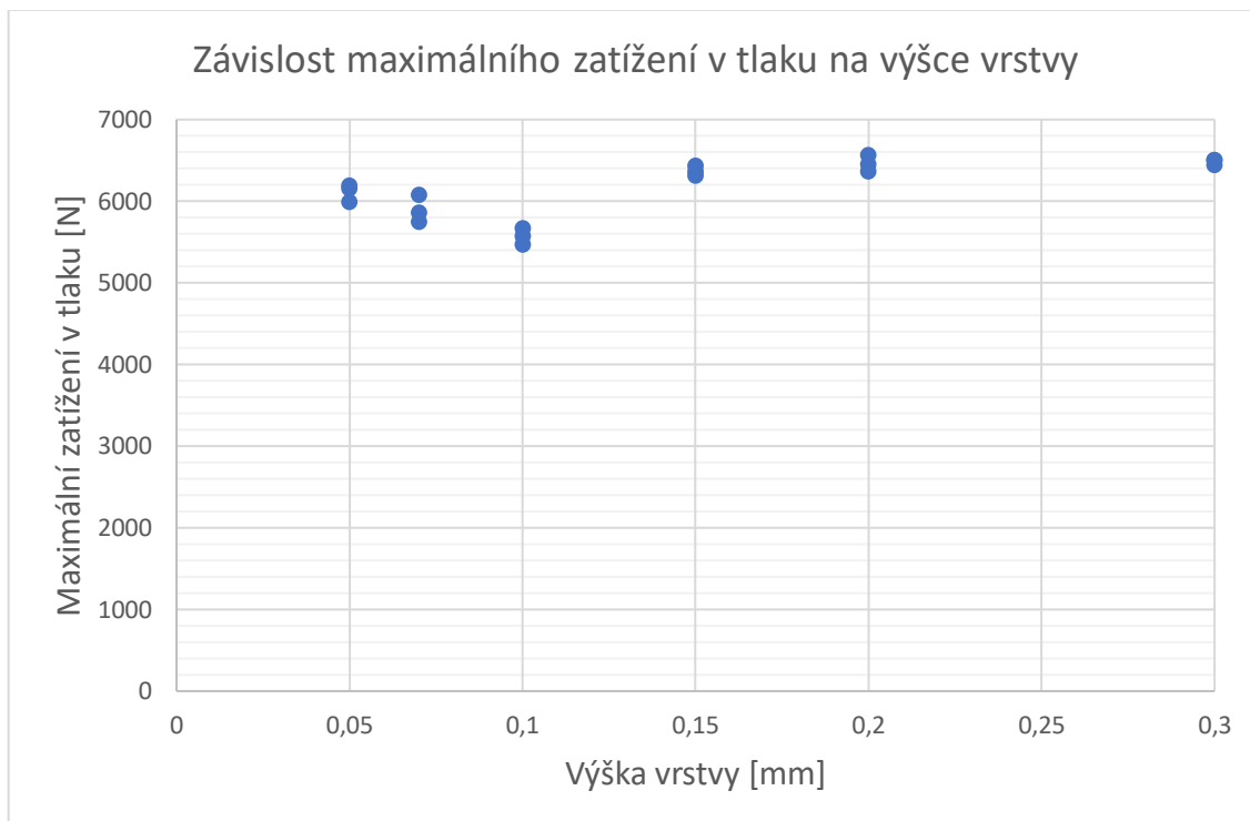
Obrázek 12: Závislost maximálního zatížení v tlaku na výšce vrstvy
