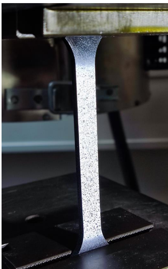
Obrázek 14: Záběr z tahové zkoušky
