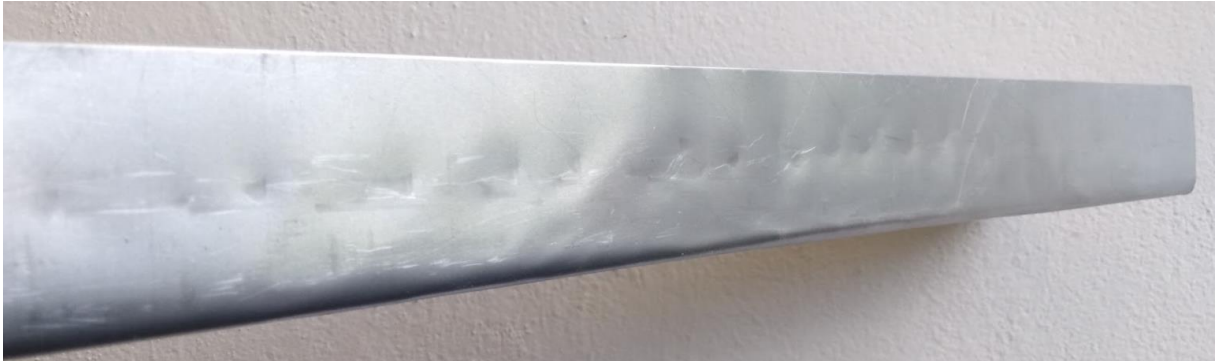
Obrázek 28: Defekty na ohýbaném profilu
