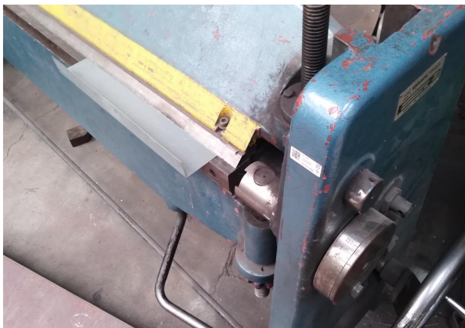
Obrázek 26: Ohýbání profilu na konvenční ohýbačce
