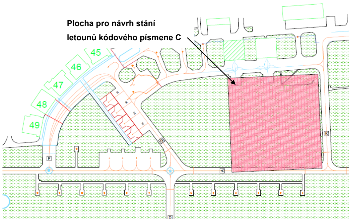
Obrázek 24 Plocha pro návrh stání letounů kódového písmene C
