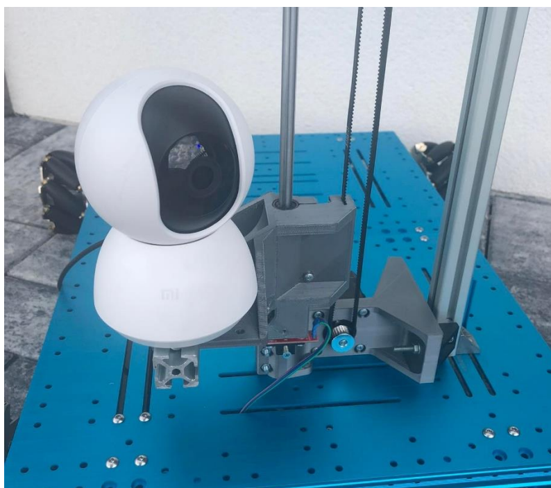
Obrázek 4.5: Připevnění kamery na platformu
