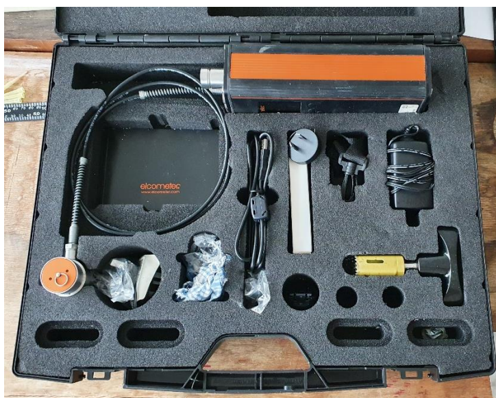
Obr. č. 20: Hydraulický odtrhoměr Elcometer 510 [foto autor]
