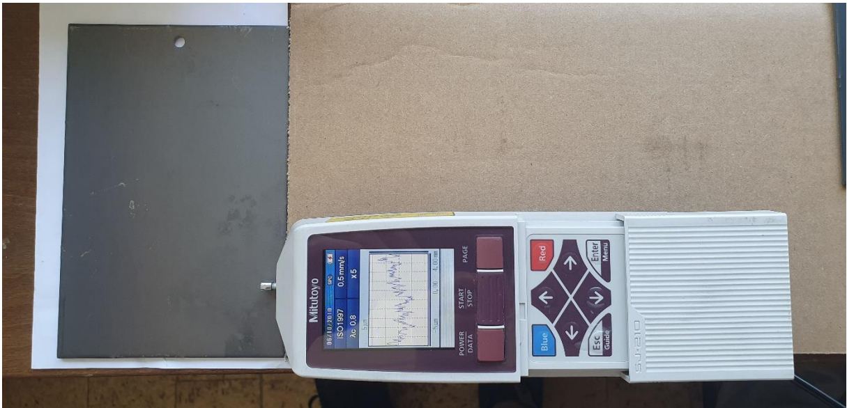
Obr. č. 34: Měření drsnosti povrchu drsnoměrem [foto autor]
