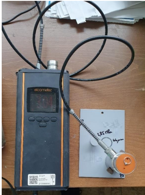
Obr. č. 40: Průběh odtrhové zkoušky [foto autor]
