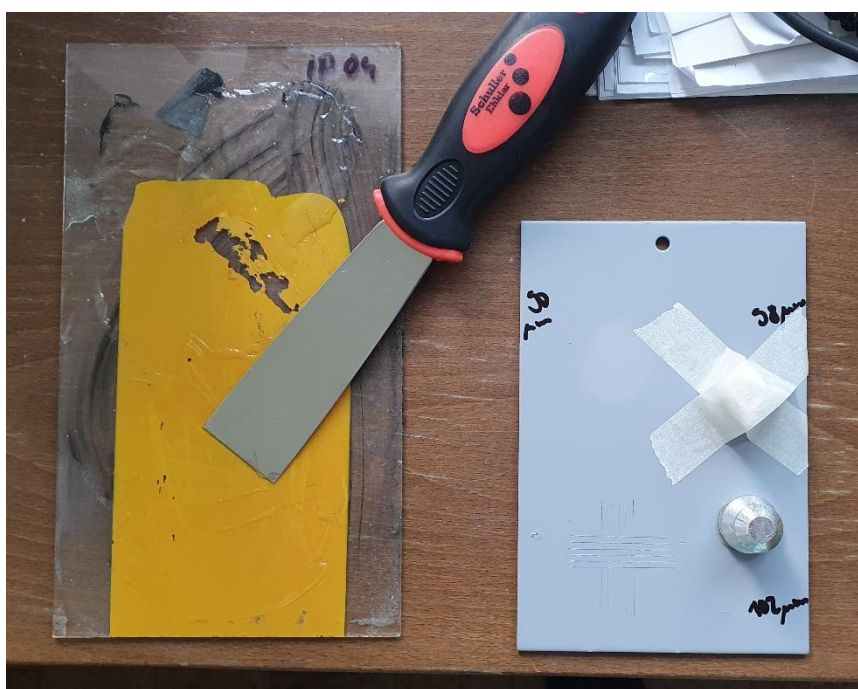
Obr. č. 38: Lepení odtrhových tělísek [foto autor]
