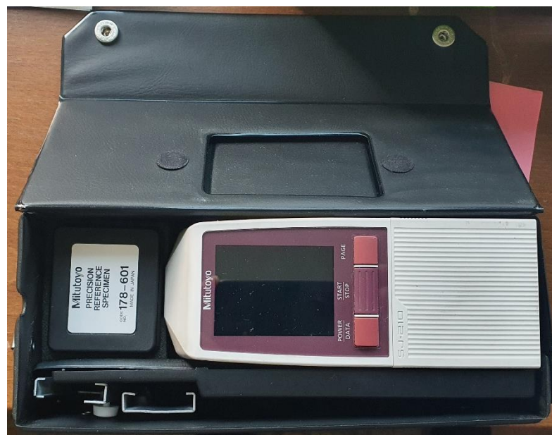
Obr. č. 16: Drsnoměr Mitutoyo SJ-210 [foto autor]
