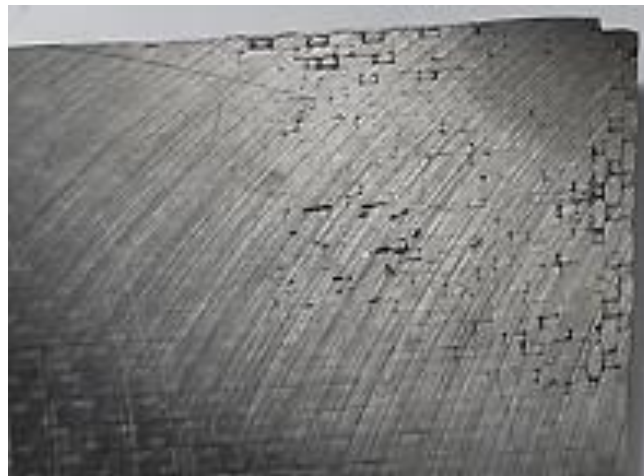
Obrázek 41: Vytržení vláken pod otiskem ventilu
