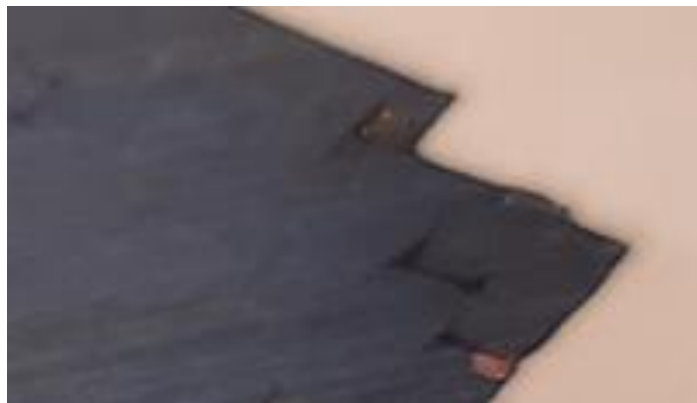
Obrázek 39: Nepravidelný roh vzorku při nedůsledném pokládání vrstev
