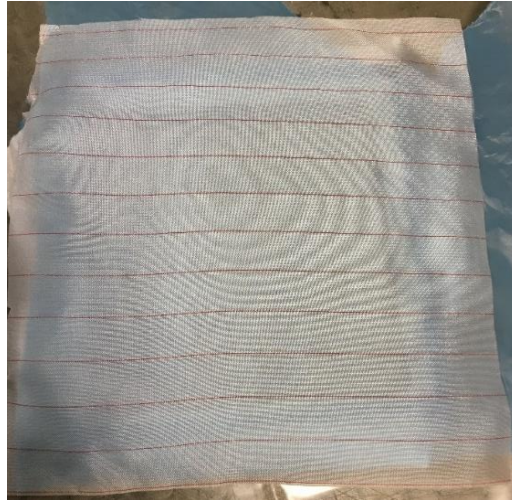
Obrázek 32: Umístění strhávací fólie na vzorek
