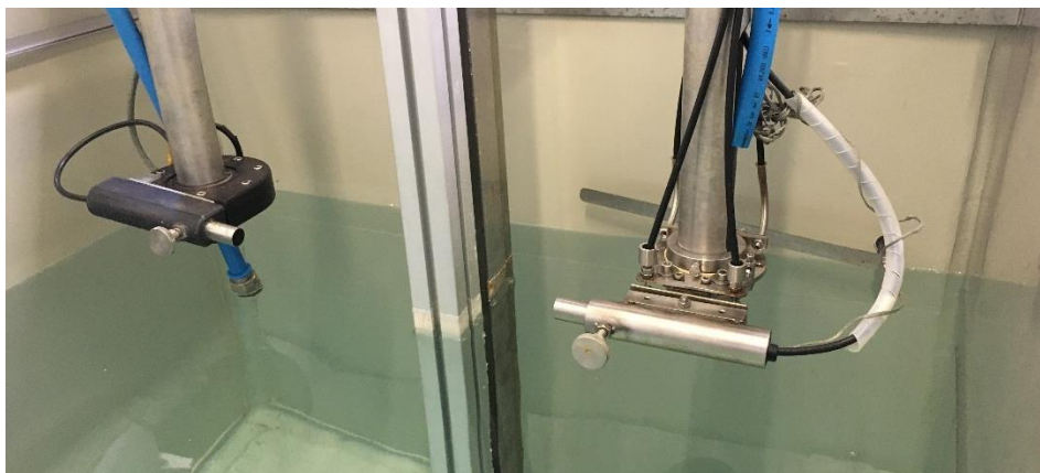
Obrázek 54: Dvojice sond pro UT metodu imersní průchodovou v úchopném zařízení
