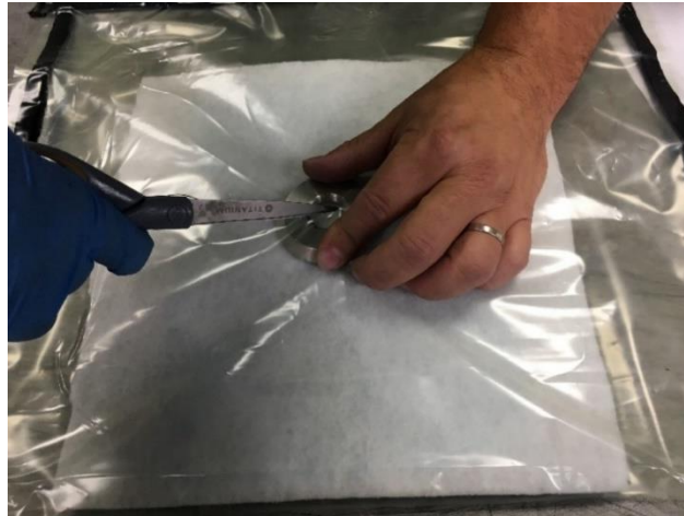
Obrázek 35: Vytváření otvoru v místě závitového otvoru části ventilu umístěné ve vakuovací fólii
