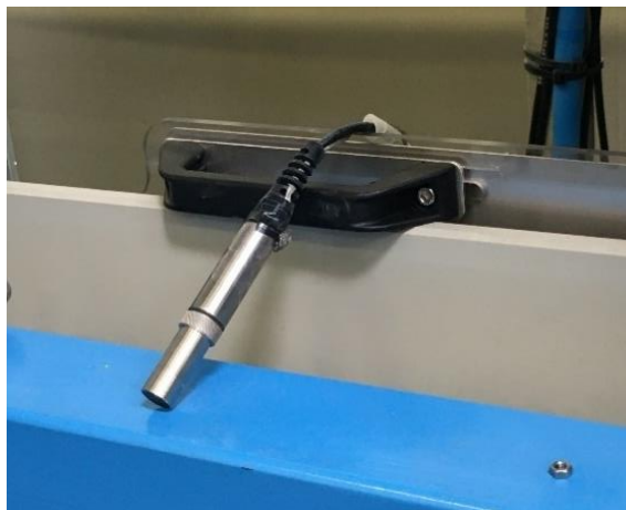
Obrázek 44: Montáž sondy do úchopného zařízení
