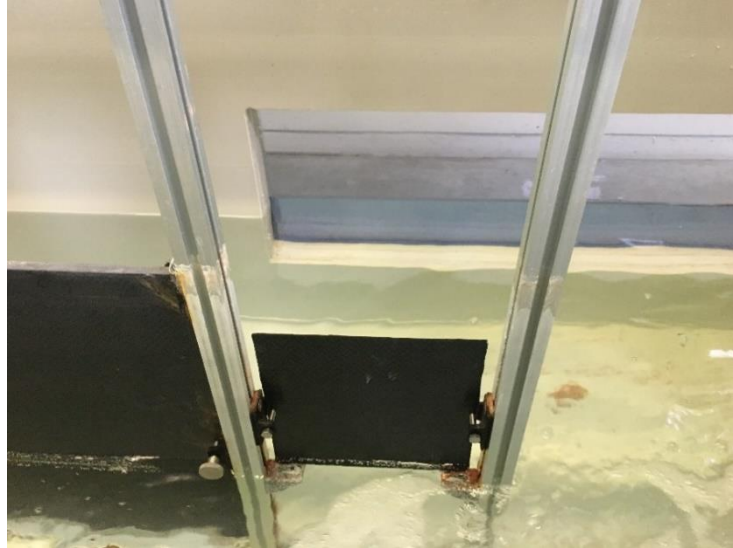
Obrázek 43: Upevněný vzorek v ocelové konstrukci v bazénu
