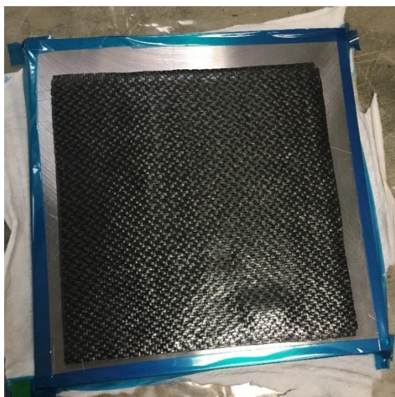
Obrázek 31: Umístění vrstev na formu
