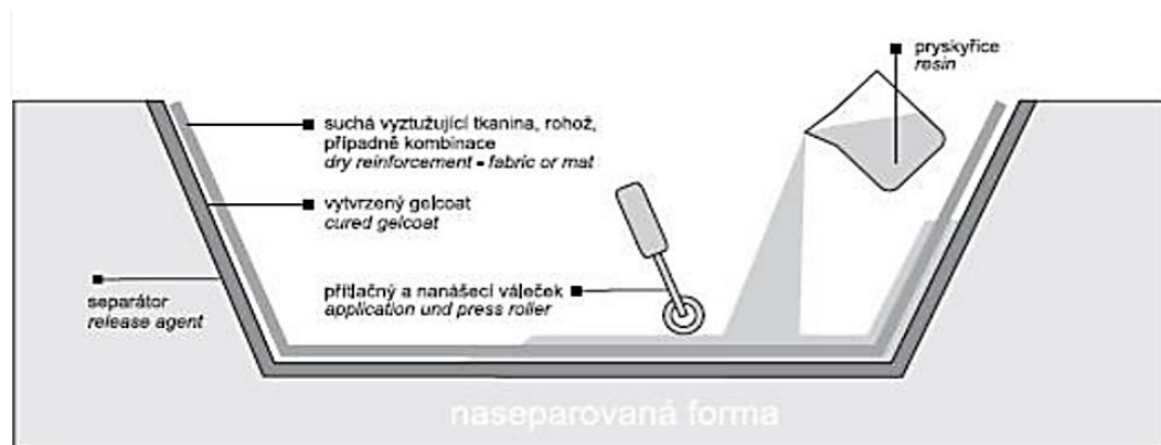
Obrázek 5: Technologie ručního kladení [7]
