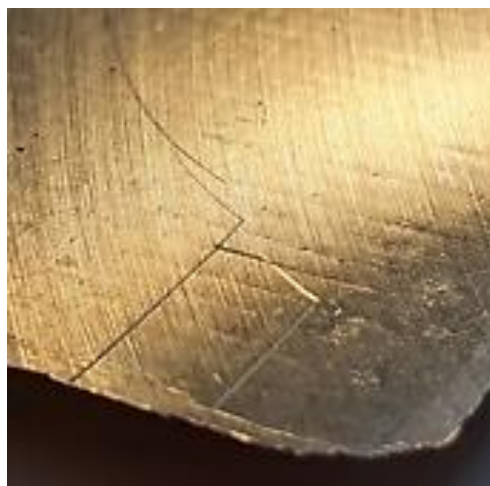
Obrázek 40: Poškrábání povrchu v důsledku manipulace se vzorkem
