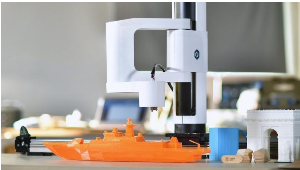
Obrázek 6 Příklad SCARA tiskárny Dobot M1 – převzato z [10]
