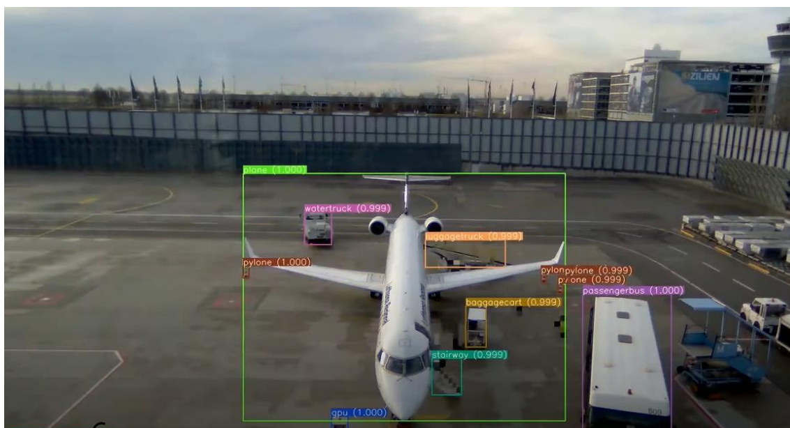
Obrázek č. 8 – Pracovní rozhraní systému ZeroG, identifikace objektu na stojánce [31]
